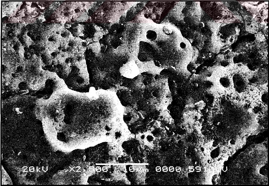
Resim 6.2.2.3. Nd:YAG lazer ve Opb dentin bonding ajan uygulanan örneğin kopma yüzeyi
