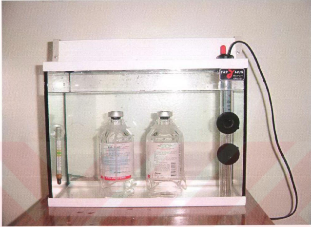
Şekil 3.6. İrrigasyon sıvı sıcaklığını ayarlamak için kullanılan ısı sistemi
