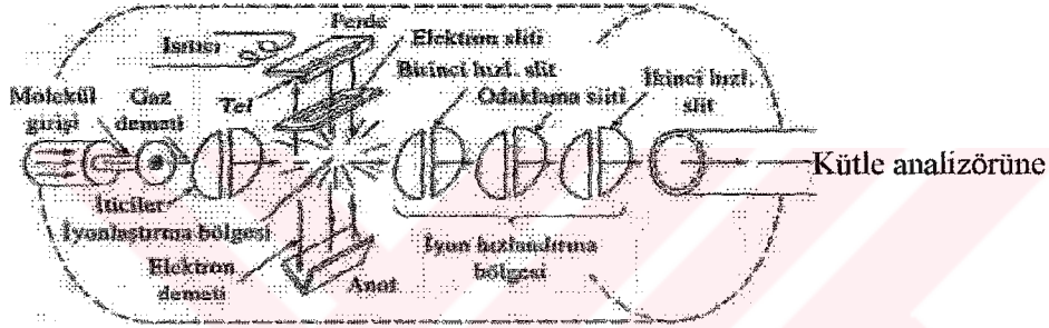
Şekil 3.2. Elektron-impakt kaynağının yapısı [28]
