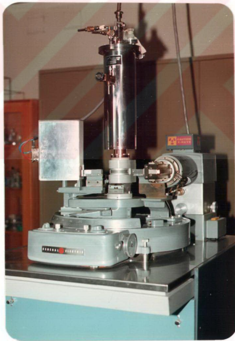
Şekil 7.1. Alçak sıcaklık x-ışını kırınımı toz kriyostatı.
