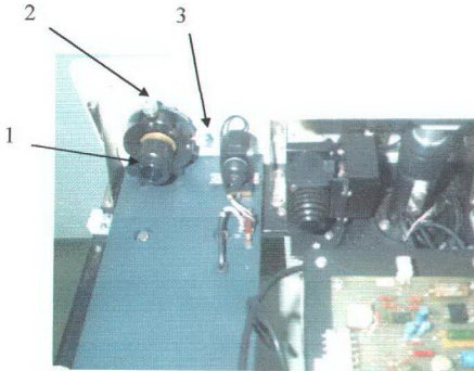
Şekil 5. : Lazer ışınına fiber optik kabloya odaklayan aparat
