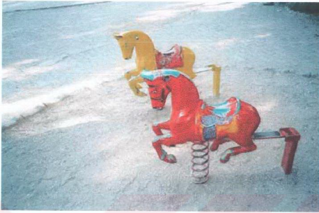
Şekil 4.44. Yaylı bineğin tutma kolları kırık.
