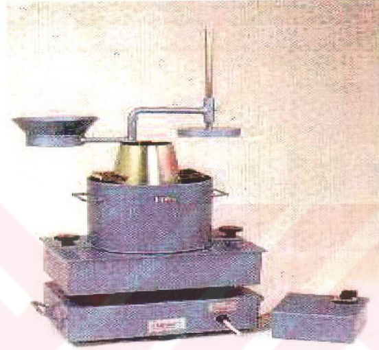
Şekil 2.4. Çökme Deneyinde Kullanılan Çökme ve VeBe Deney Aleti
