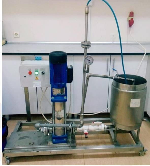
Şekil 3.1. Tez çalışması kapsamında kullanılan hidrodinamik kavitasyon sistemi
