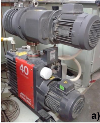
Şekil 0.18. a) Vakumlama için mekanik pompa b) Turbo moleküler pompa fotoğrafları
