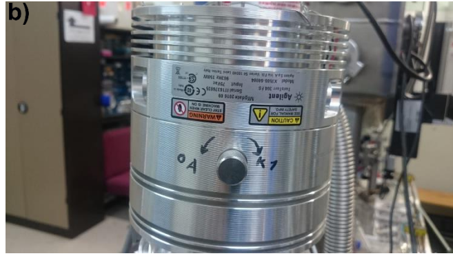
Şekil 0.18. a) Vakumlama için mekanik pompa b) Turbo moleküler pompa fotoğrafları
