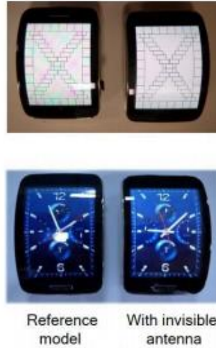
Şekil 6.2 Optiksel saydam anten entegre edilmiş akıllı saat (Hong 2017)
