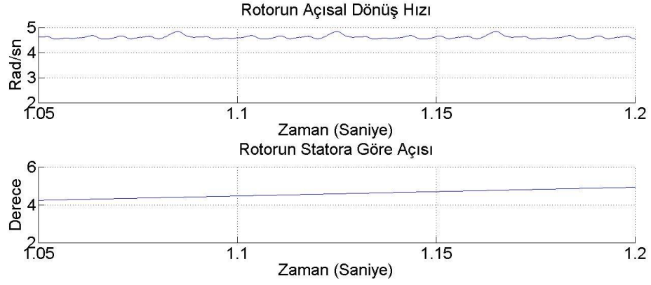
Şekil 6.12: 25-Hz yüksüz çalışmada rotorun açısal hızı ve statora göre açısı
