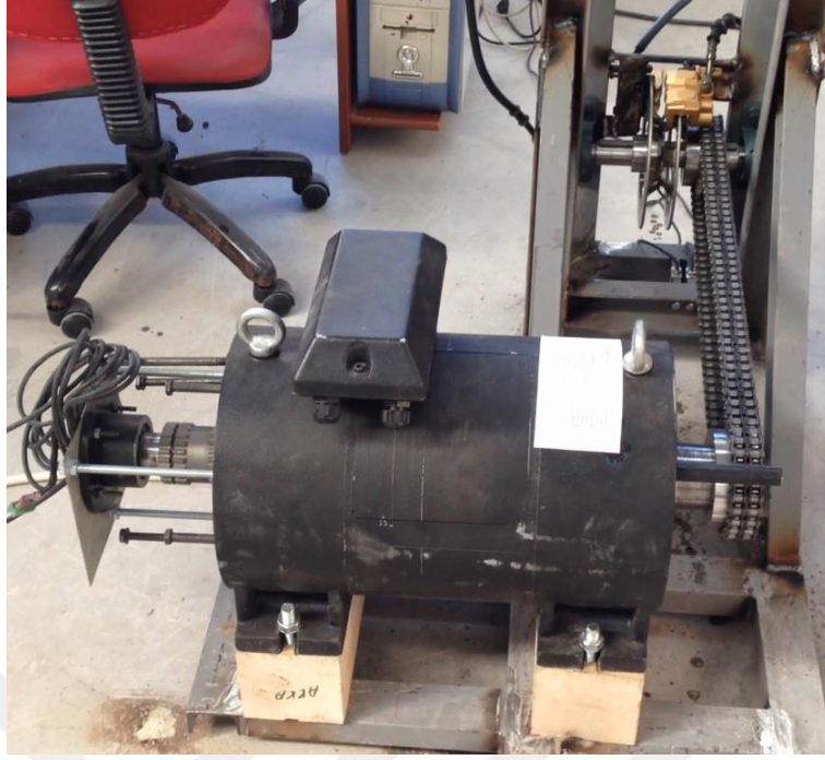
Şekil 7.7: Senkron motor ve yük sistemi deney seti
