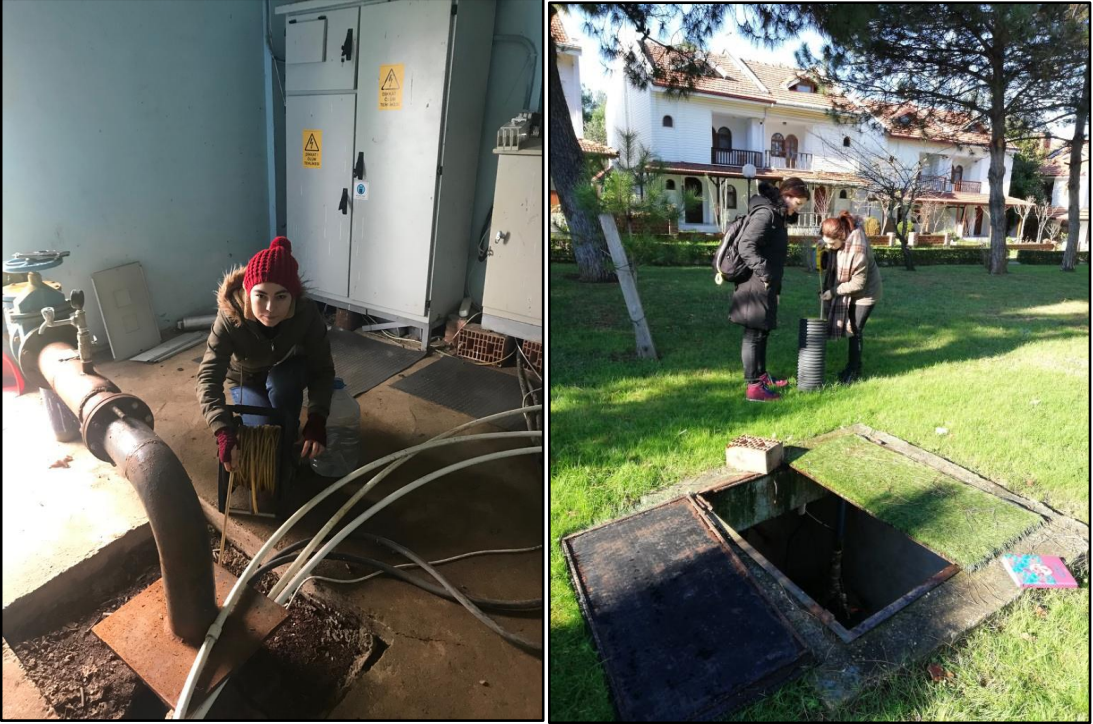
Şekil 5.3. Arazide KLL tipi kuyu düdüğü ile yeraltı su seviye ölçümü
