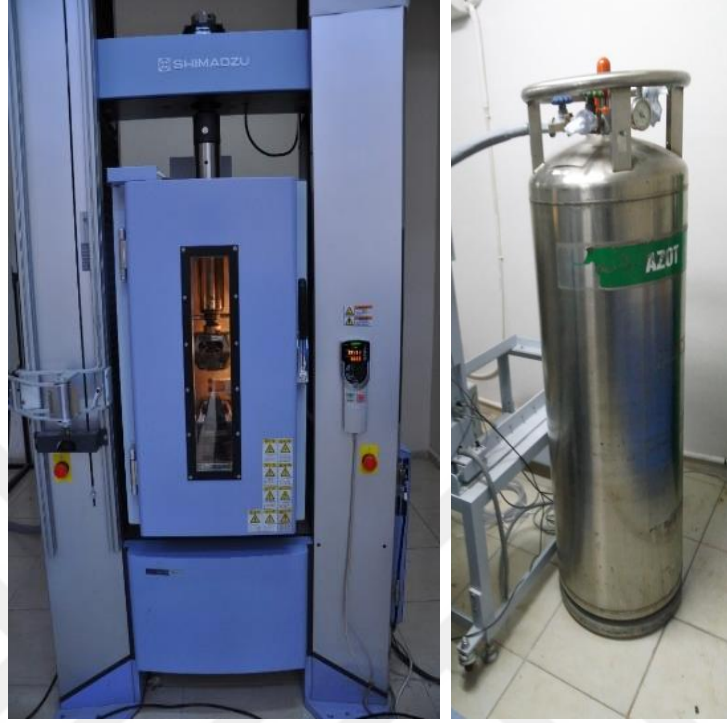
Şekil 15. Çift konsol kiriş testi ve sıvı azot tankı
