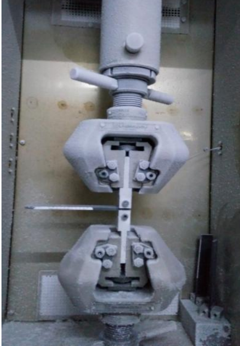
Şekil 14. Karbon lifi/epoksi tabakalı kompozit malzemenin çok düşük ortam sıcaklıklarında gerçekleştirilen mod I kırılma testleri.
