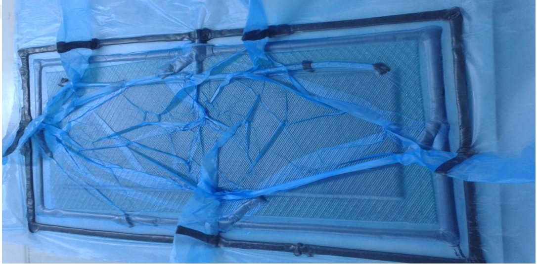
Şekil 10. Tabakalı kompozit test numunelerinin üretimi Vakum torbalama tekniği
