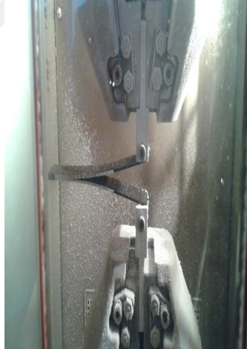
Şekil 14. Karbon lifi/epoksi tabakalı kompozit malzemenin çok düşük ortam sıcaklıklarında gerçekleştirilen mod I kırılma testleri.
