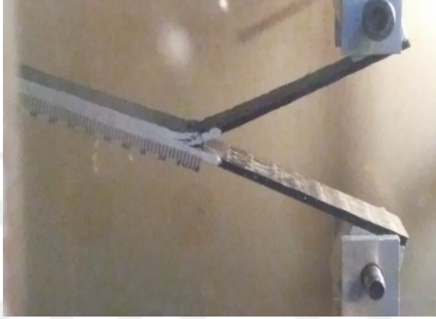
Şekil 23. 60°C ve üzeri ortam sıcaklıklarında çatlak kökünden kırılan numune örneği.
