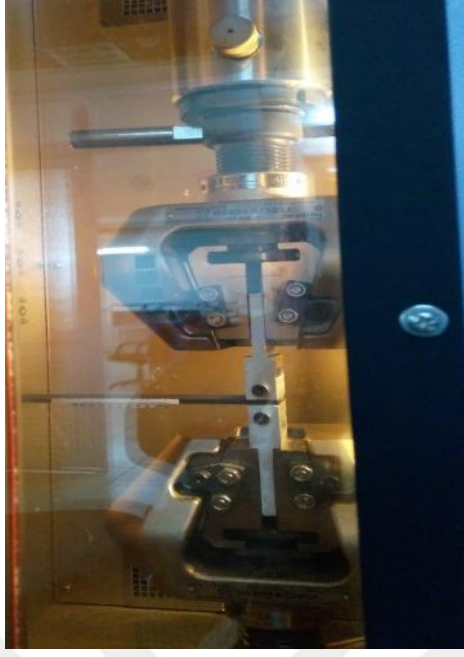
Şekil 13. Karbon lifi/epoksi tabakalı kompozit malzemenin çok yüksek ortam sıcaklıklarında gerçekleştirilen mod I kırılma testleri.
