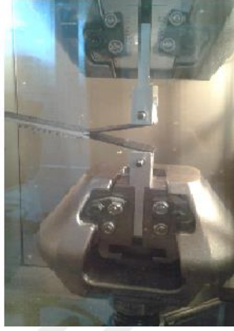
Şekil 13. Karbon lifi/epoksi tabakalı kompozit malzemenin çok yüksek ortam sıcaklıklarında gerçekleştirilen mod I kırılma testleri.
