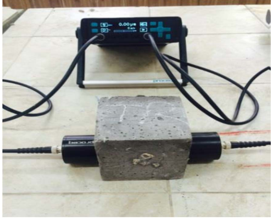
Şekil 3.3. Ultrases geçiş hızı deney cihazı
