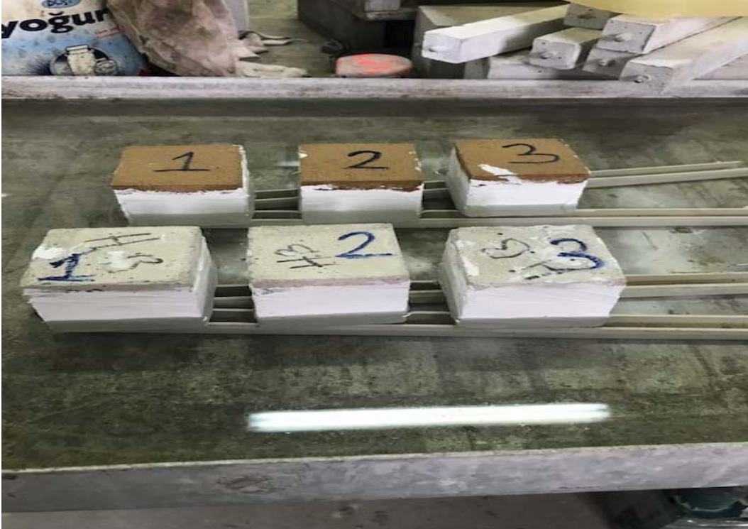
Şekil 3.5. Kılcal su emme deneyine tabi tutulan numuneler
