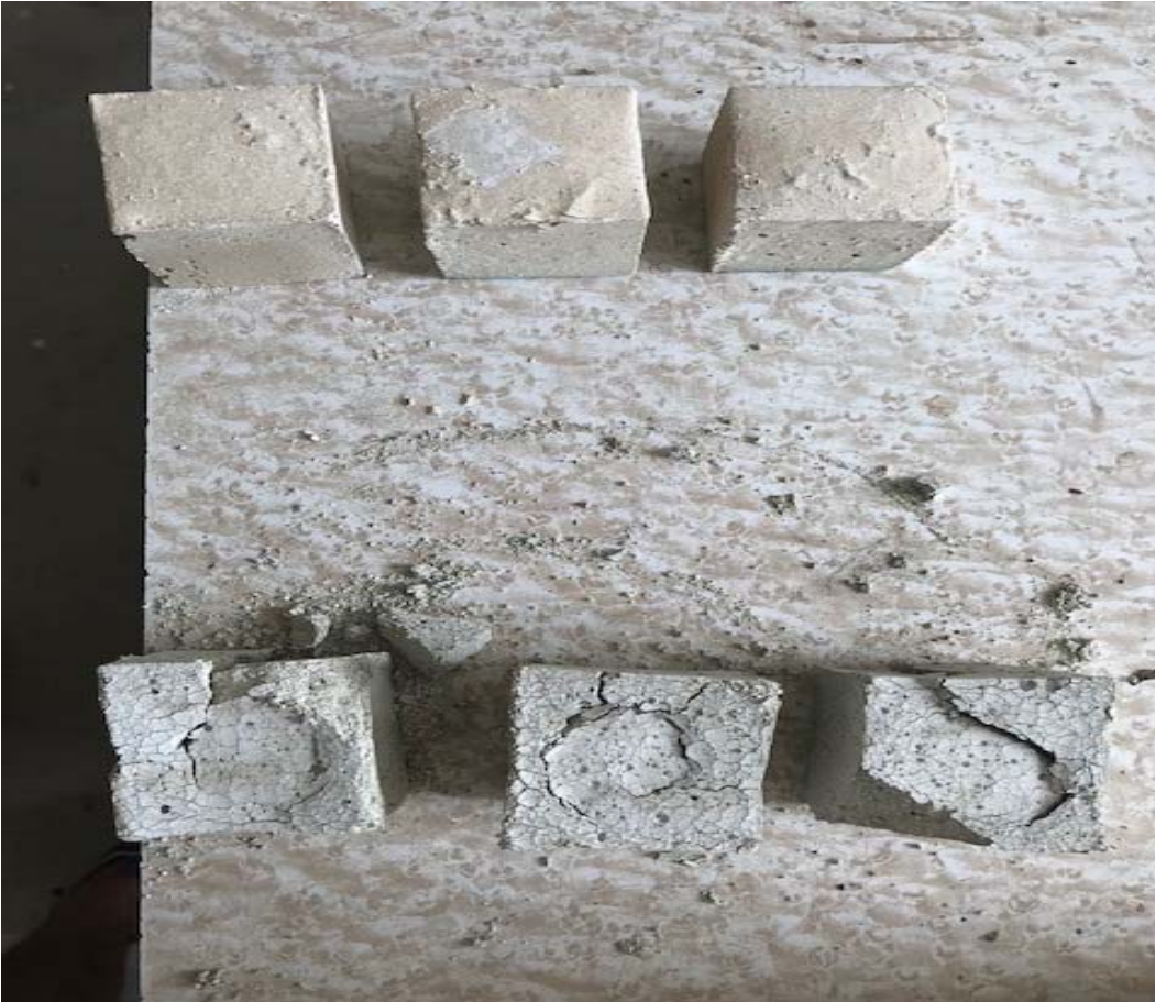
Şekil 4.12. 900°C sıcaklığa maruz kalan geopolimer harç (üstte) ve çimento harç numuneleri (altta)
