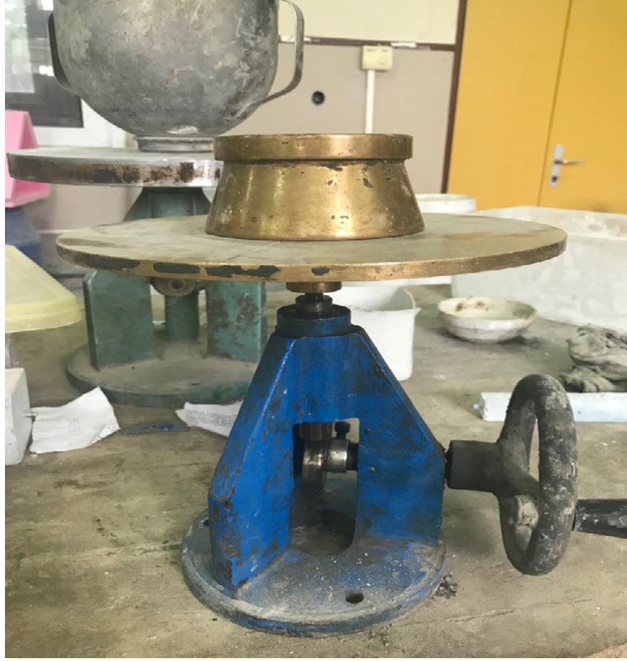
Şekil 3.2. Yayılma tablası düzeneği
