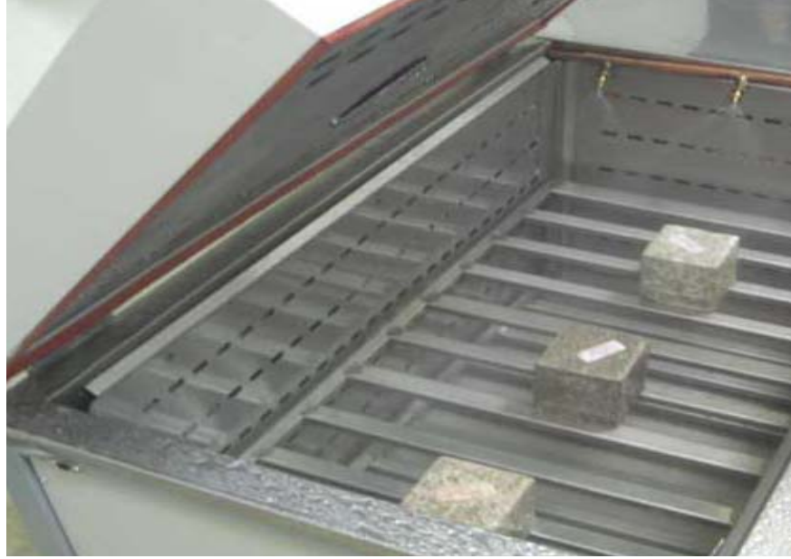
Şekil 3.8. Donma-çözülme deneyine tabi tutulan numuneler
