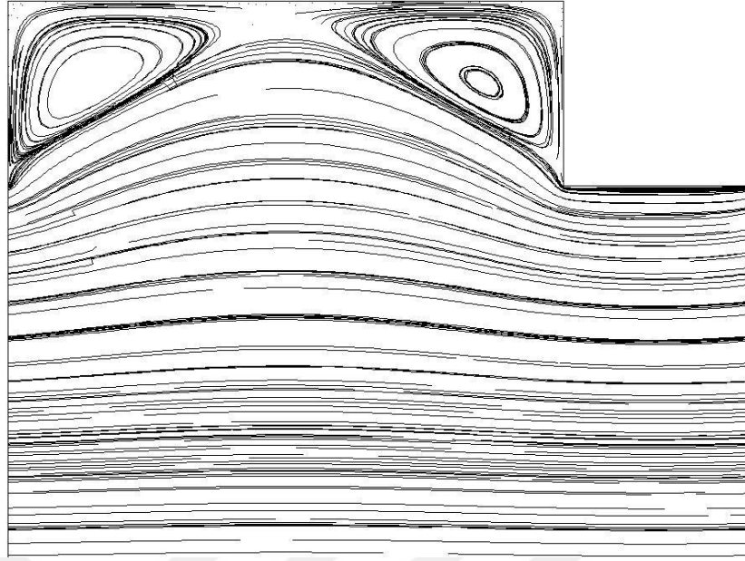
Şekil 5.5. Pürüzler arası boşlukta oluşan çevrilerin farklılaşması Re=2 , k/D_{h,eş} = 0,01 , \lambda/w = 4 .
