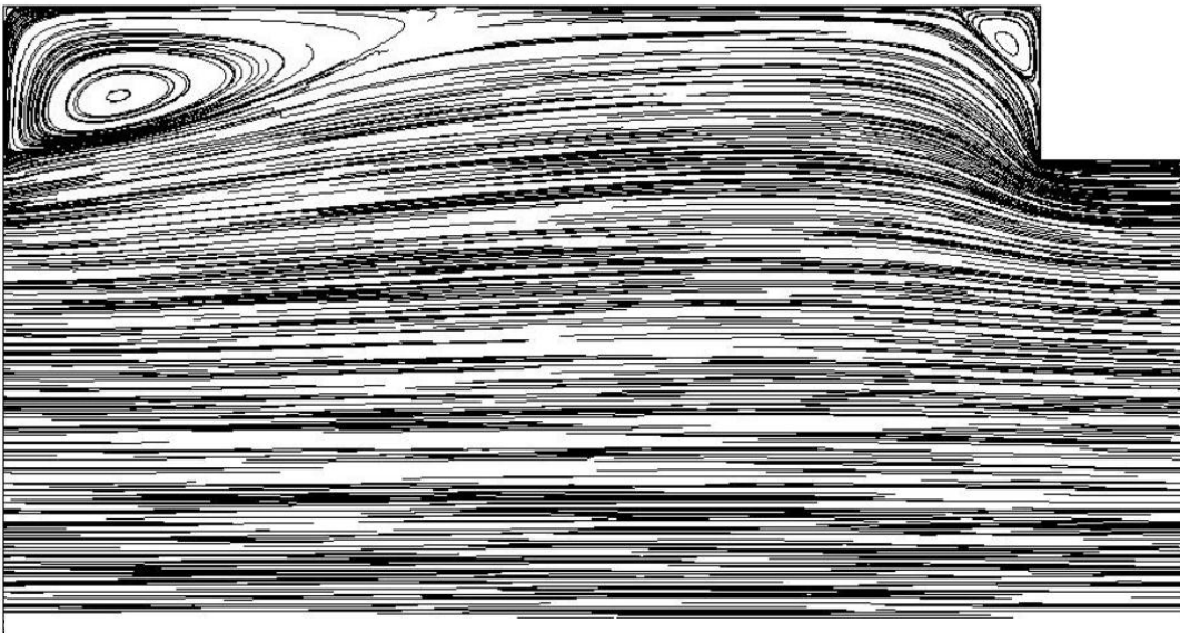
Şekil 5.8. Pürüzler arası boşlukta oluşan çevrilerin farklılaşması Re=2000 , k/D_{h,es} = 0,025 , \lambda/w = 8 .
