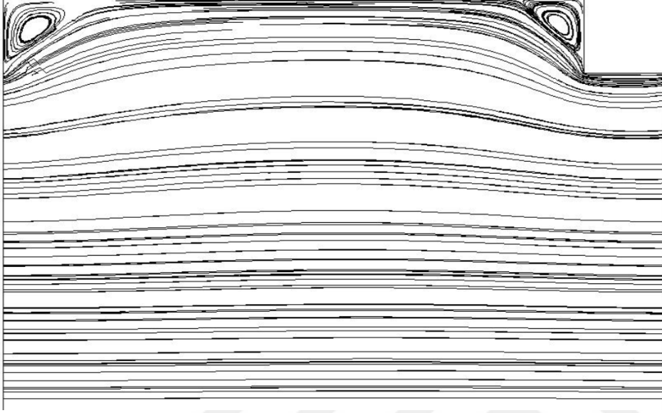
Şekil 5.7. Pürüzler arası boşlukta oluşan çevrilerin farklılaşması Re=2000 , k/D_{h,es} = 0,005 , \lambda/w = 8 .
