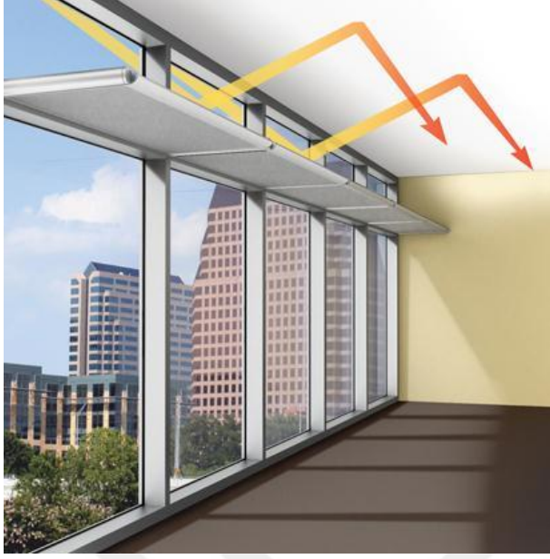
Resim 2.10. Işık rafı örneği ( www.designingbuildings.co.uk )
