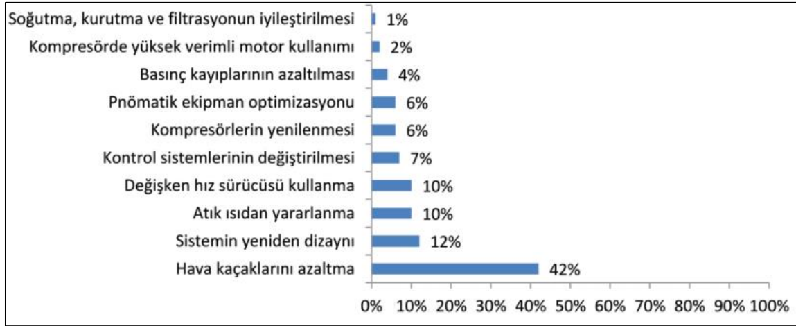
Şekil 2.8. Avrupa Birliği normlarına göre kompresörler için belirlenen tasarruf noktaları
