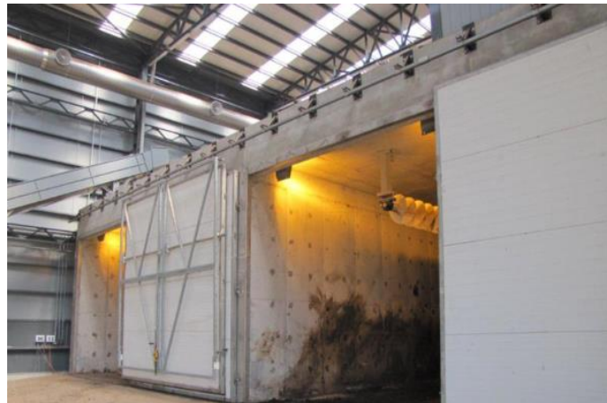
Şekil 2.32 Kapalı Statik Yığın (Tünel) Kompost Yöntemi [22]
