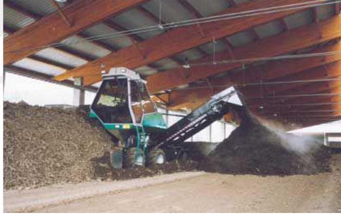
Şekil 1.2. Aktarmalı Yığın Kompostlaştırma Yöntemi Aktarma Ekipmanı Örneği [14]
