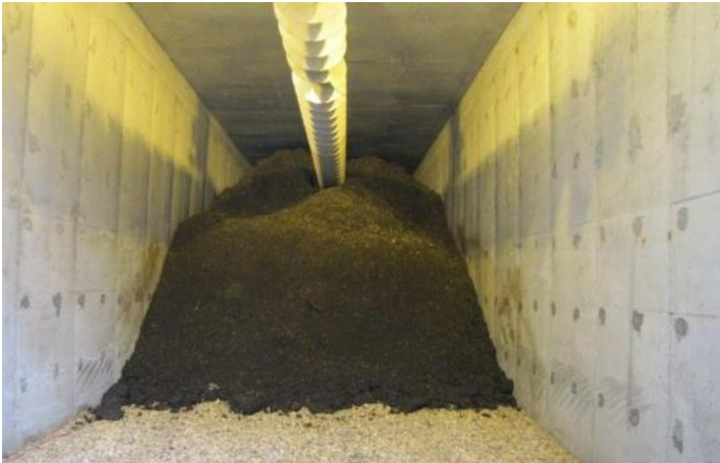
Şekil 2.15. Kapalı Statik Yığın (Tünel) Dolum Örneği [23]
