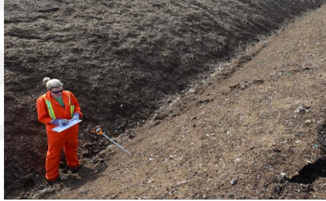
Şekil 2.10. Windrow Kompost Yığını Sıcaklık Ölçümü [20]
