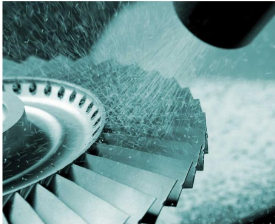
Şekil 2.2. Bir türbin çarkının bilyalı dövülmesi [33].
