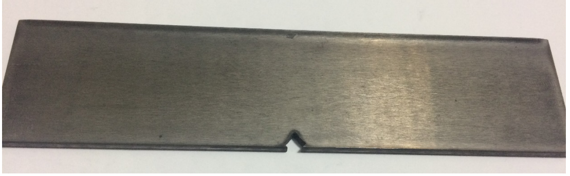
Şekil 3.6. Plazma nitrürlenmiş numune.
