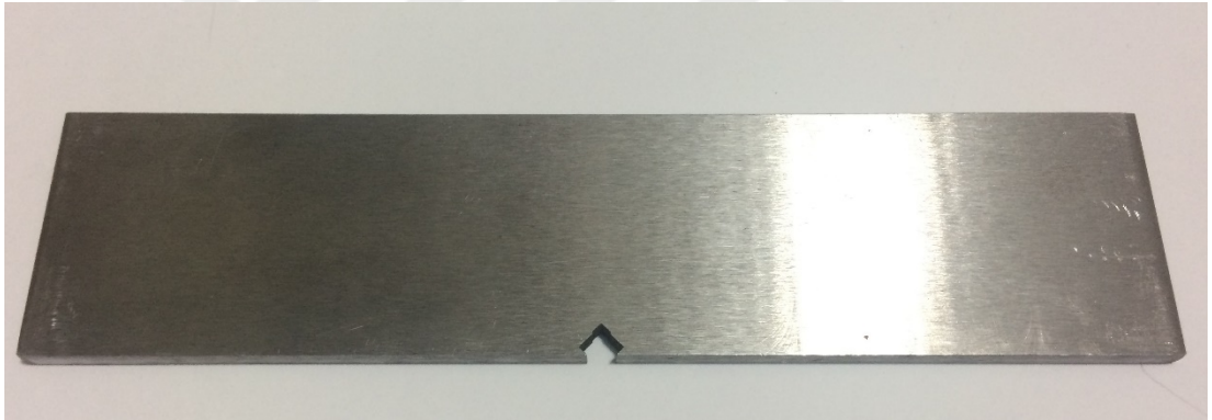
Şekil 3.3. İşlem görmemiş yorulma çatlak ilerleme numunesi.
