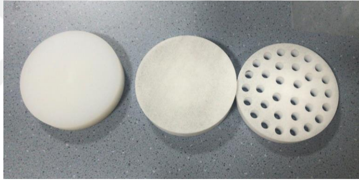
Şekil 5.1. Teflon malzemeden üretilen ASTM F-451 – 99a standardında mekanik basma testi kalıbı
