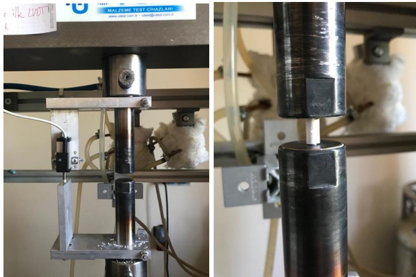
Şekil 3.12. Mekanik basma dayanımı test numunelerinin yerleştirildiği test kafaları ve test numunesinin yerleştirilmesi
