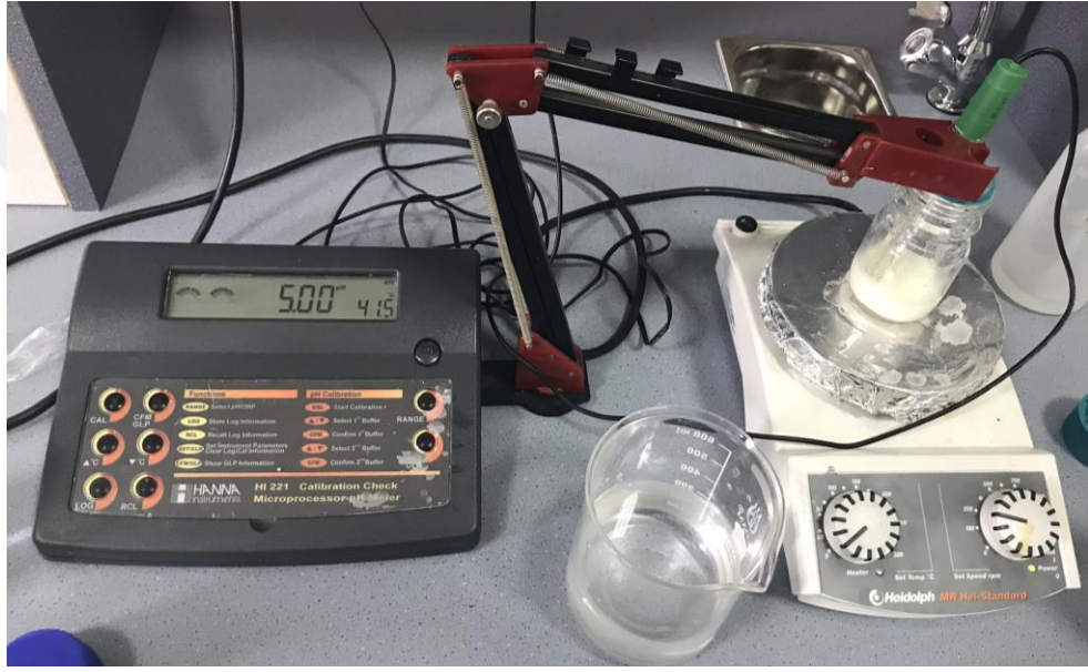
Şekil 3.3. YKZP çözeltisinin nötralizasyonunu gerçekleştirmek üzere kullanılan pHmetre düzeneği
