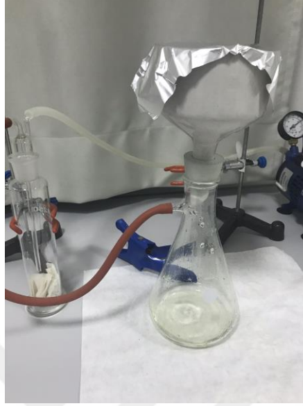
Şekil 3.6. CaS çözeltilisinin filtrasyonu için kullanılan filtrasyon düzeneđi
