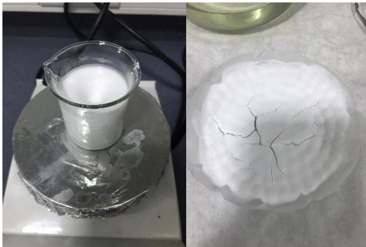
Şekil 4.2. CaS çökeltisinin EtOH ile yıkama işlemi sırasında görünüşü
