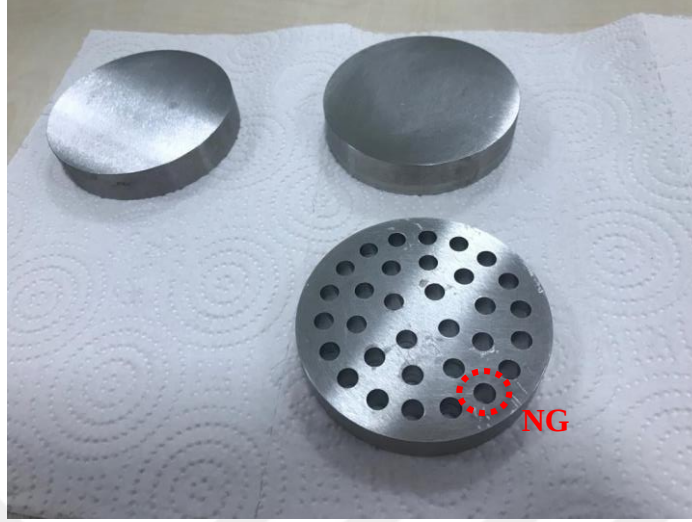
Şekil 3.8. ASTM F-451 99a standardına göre imal edilen paslanmaz çelik test kalıbı
