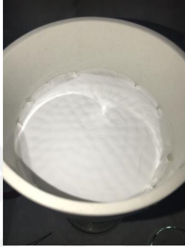
Şekil 4.1. CaS çökeltisinin filtrasyon sonrası filtre kâğıdı üzerindeki hali
