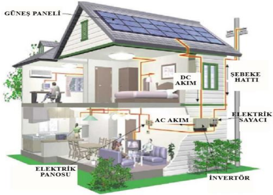
b) ON-GRİD (Şebekeye Bağımlı Fotovoltaik Sistem) (Url-16)
