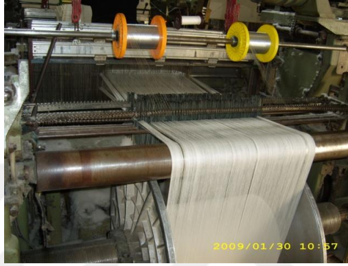
Şekil 18. : Motorlu Kara Tezgâh Detayı (Şahin Kul, 2015)
