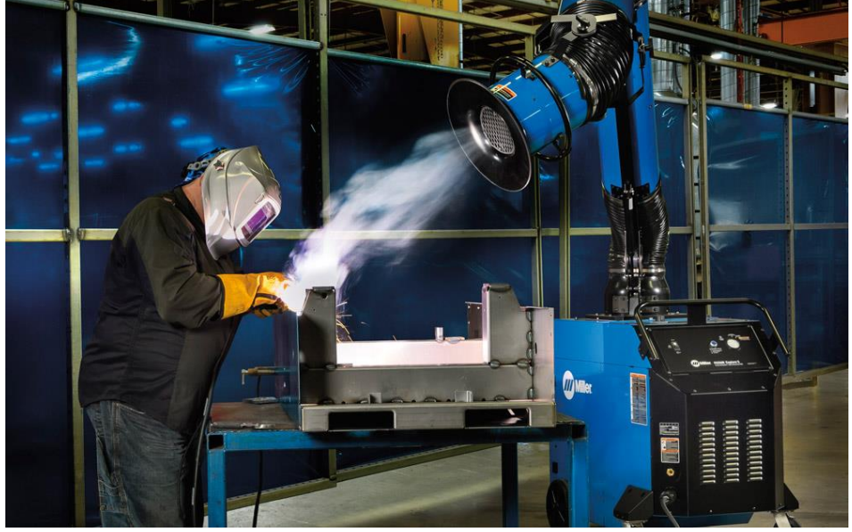
Şekil 2.3. Kaynak işlemi için bölgesel havalandırma örneği
