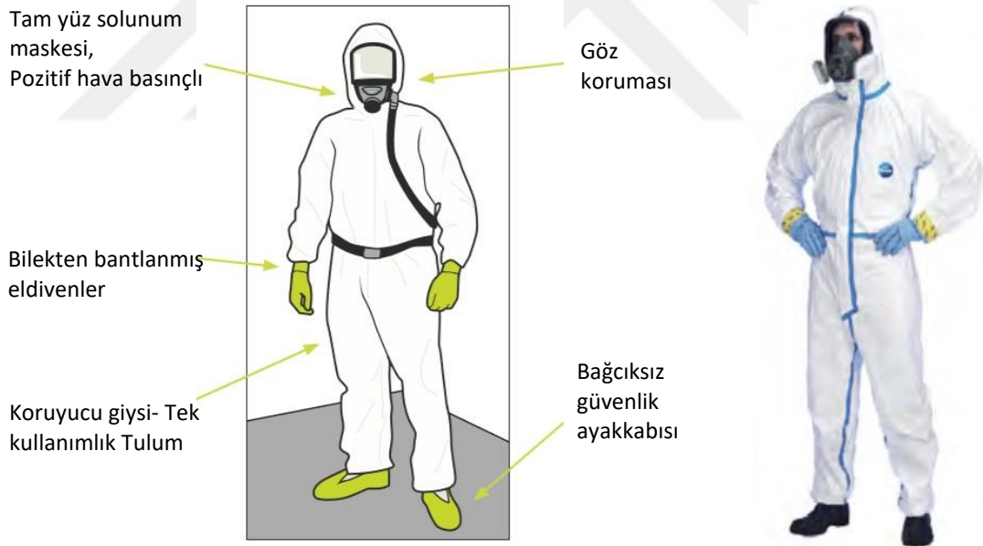
Şekil 4. 17 Asbestli çalışmalarda kullanılan koruyucu giysiler[200]
