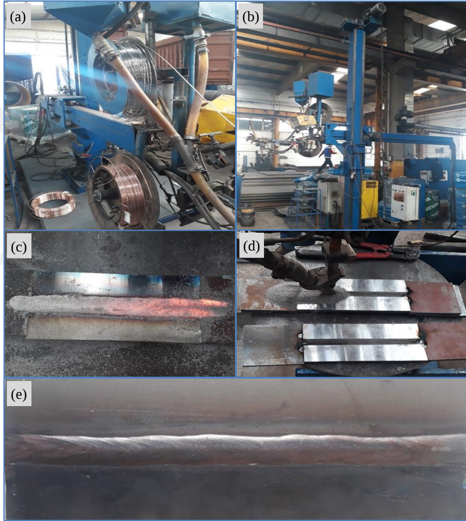
Şekil 6.2. Tozaltı ark kaynak işlemi a) Kaynak makinası yandan görüntüsü, b) kaynak makinası önden görüntüsü, c) kaynak işlemi devam ederken, d) kaynak işlemi sonrasında ergiyen koruyucu toz cürufu ve e) kaynağın temizlendikten sonraki son hali.
