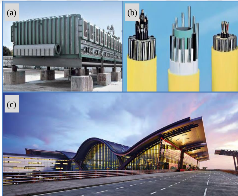
Şekil 3.1. Farklı alanlarda kullanılan dubleks paslanmaz çelik örnekleri a) S32101 ve S32205 dubleks paslanmaz çelikler ile inşa edilen çok aşamalı tuzdan arındırma üniteleri [54], b) Deniz aşırı petrol ve gaz uygulamalarında kullanılan 2507 dubleks paslanmaz çelik borular [55], c) New Doha Uluslararası Havaalanı’nın dubleks paslanmaz çelik çatısı [54].
