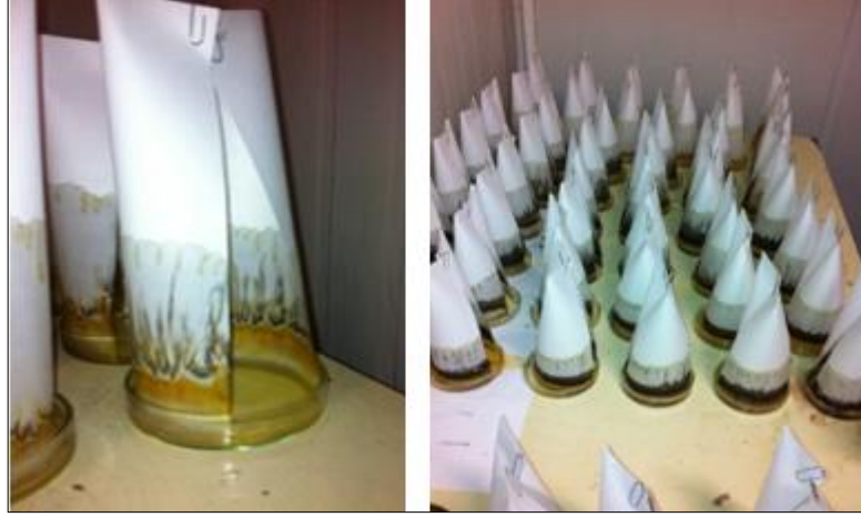
Şekil 3.10. \text{FeSO}_4 çözeltisinin kromatografi kağıdına emdirilmesi ve kurutulması.
