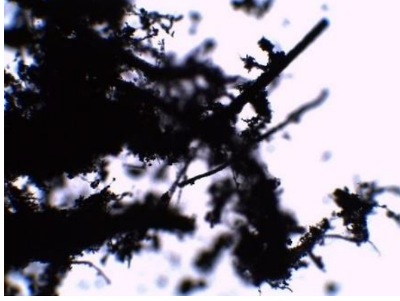
Şekil 4.14 Asbest liflerinin stereo mikroskop ile görüntüsü
