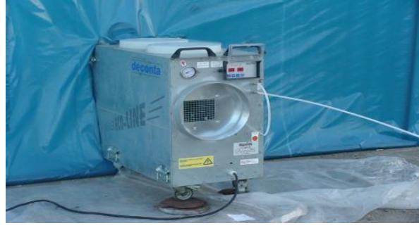
Şekil 5.7 Negatif basınç ünitesi (NPU)
