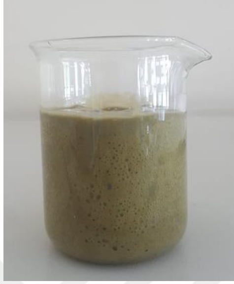
Şekil 3.4. Fermantasyon ortamında doğal substrat kaynağı olarak kullanılan şeker kamışı pekmezi artığı (ŞKPA)
