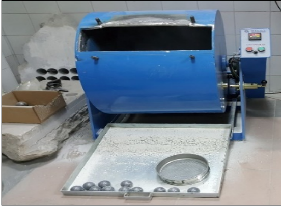
Fotoğraf 6.4. Los Angeles aşınma tamburu (a) ve deneylerde kullanılan test numunesi (b)
