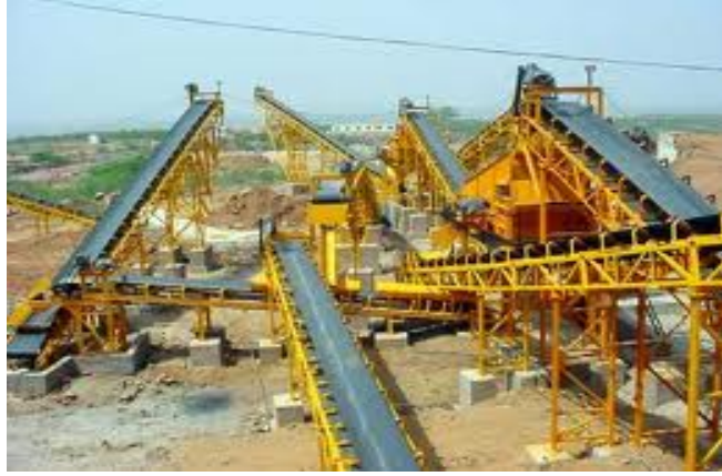
Fotoğraf 3.14. Agrega tesislerinde kullanılan örnek bant konveyör (www.muhendislikbilgileri.com)
