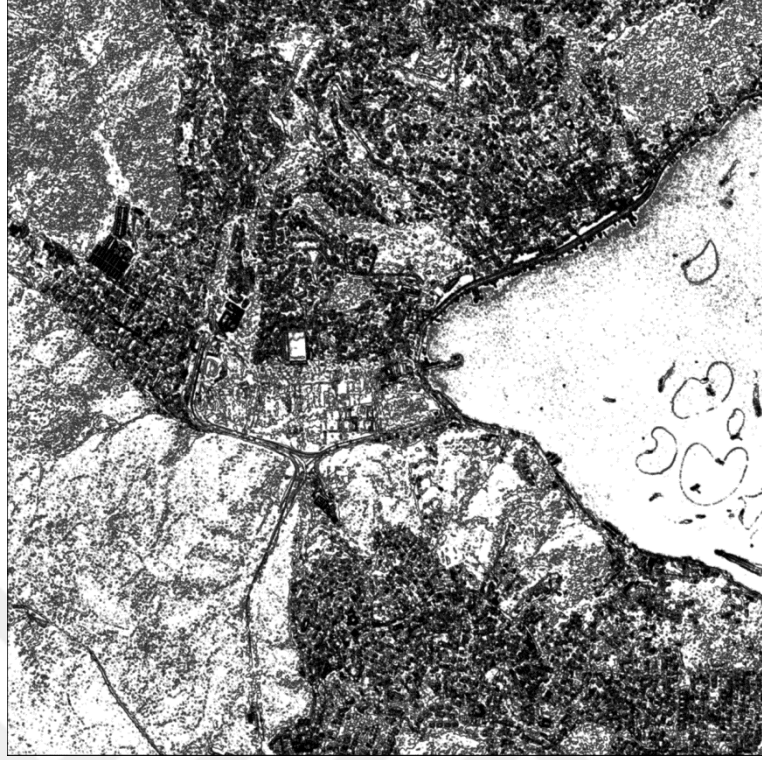
Şekil 4.27. Standart doku ölçütlerinden 5x5 piksellik pencere yöntemiyle oluşturulan ikinci açısai moment görüntüsü
