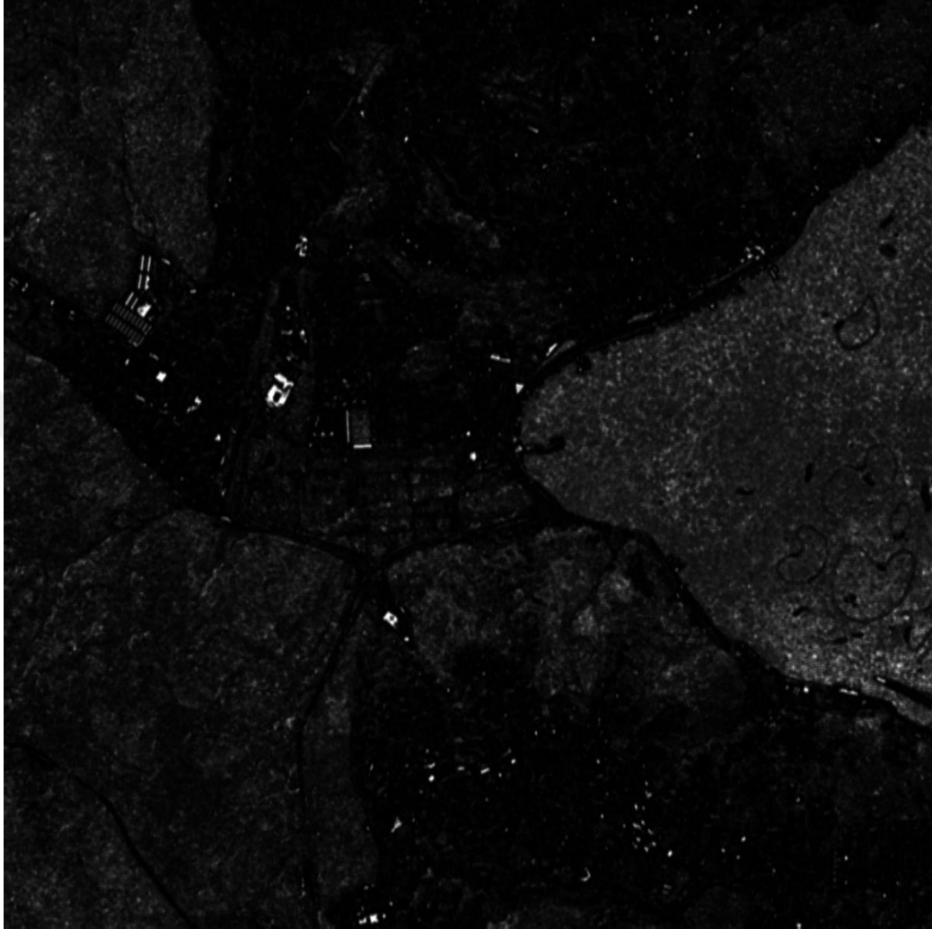
Şekil 4.37. SAR modeli ile 5x5 boyutlu pencere ve 4 piksel komşuluk ile oluşturulan açısal ikinci moment görüntüsü
