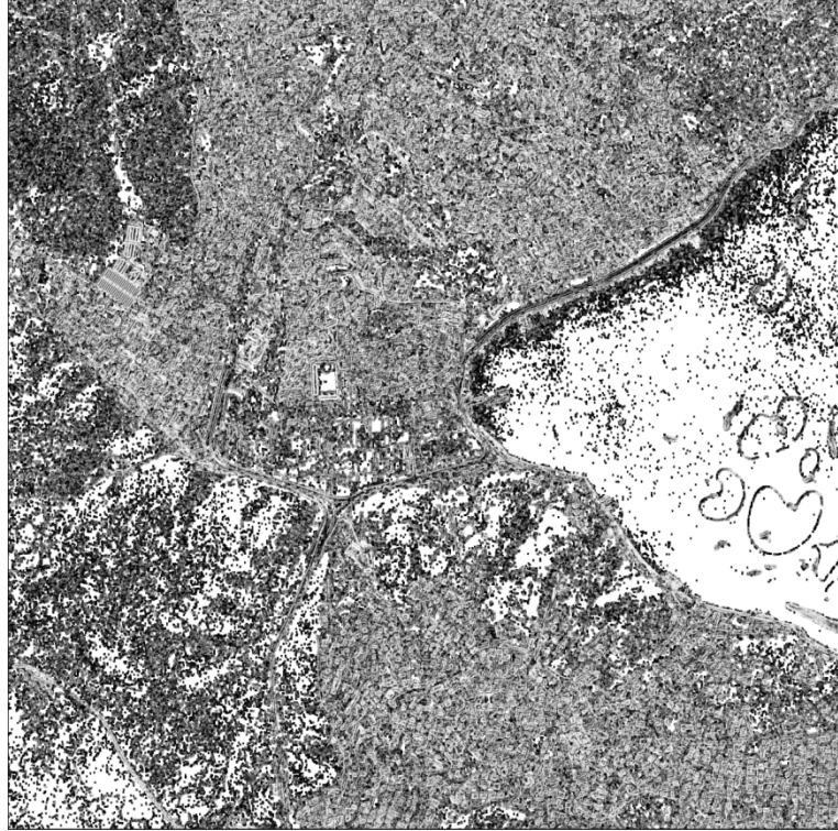
Şekil 4.26. Standart doku ölçütlerinden 5x5 piksellik pencere yöntemiyle oluşturulan korelasyon görüntüsü
