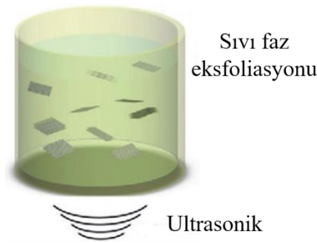
Şekil 3.5. Grafitin tek plakalı veya az plakalı GNP yapılarına sıvı fazda sonikasyon tekniği ile eksfoliasyonu (Bonaccorso, 2012)
