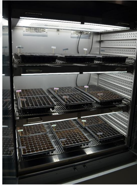
Şekil 3.12: Viyollerin bitki yetiştirme kabinine yerleştirilmesi.
