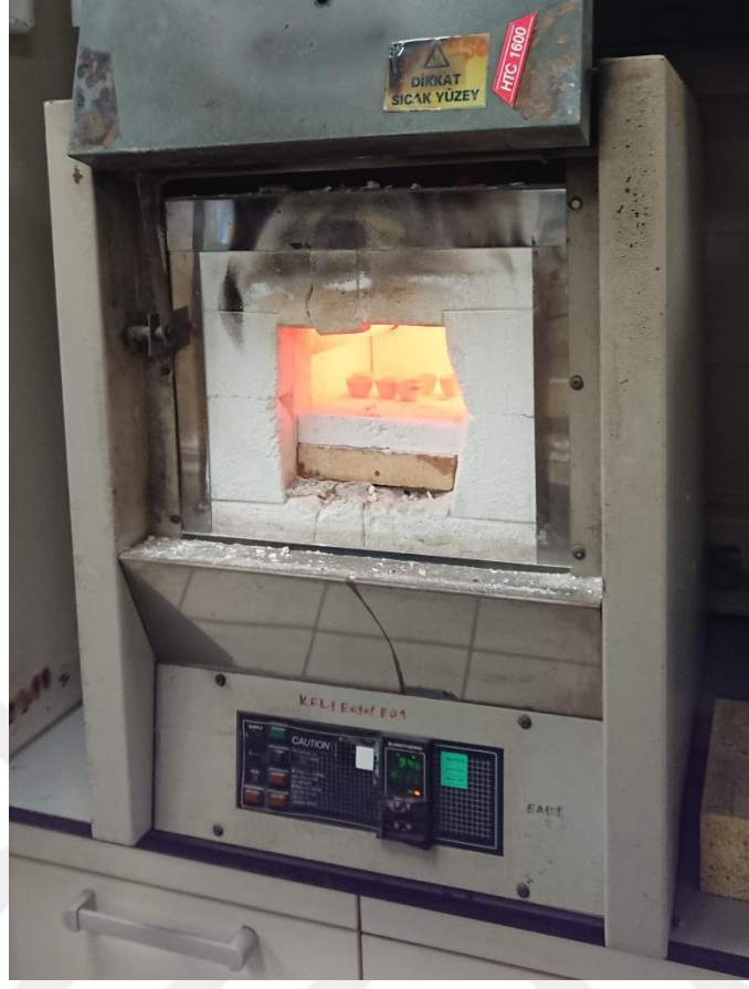
Şekil 3.9 Kızdırma kaybı deneyi
