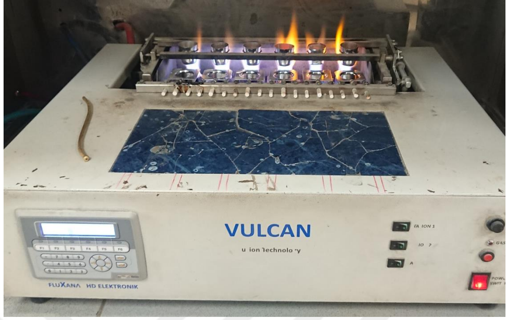
Şekil 3.5 XRF klinker tableti hazırlanması
