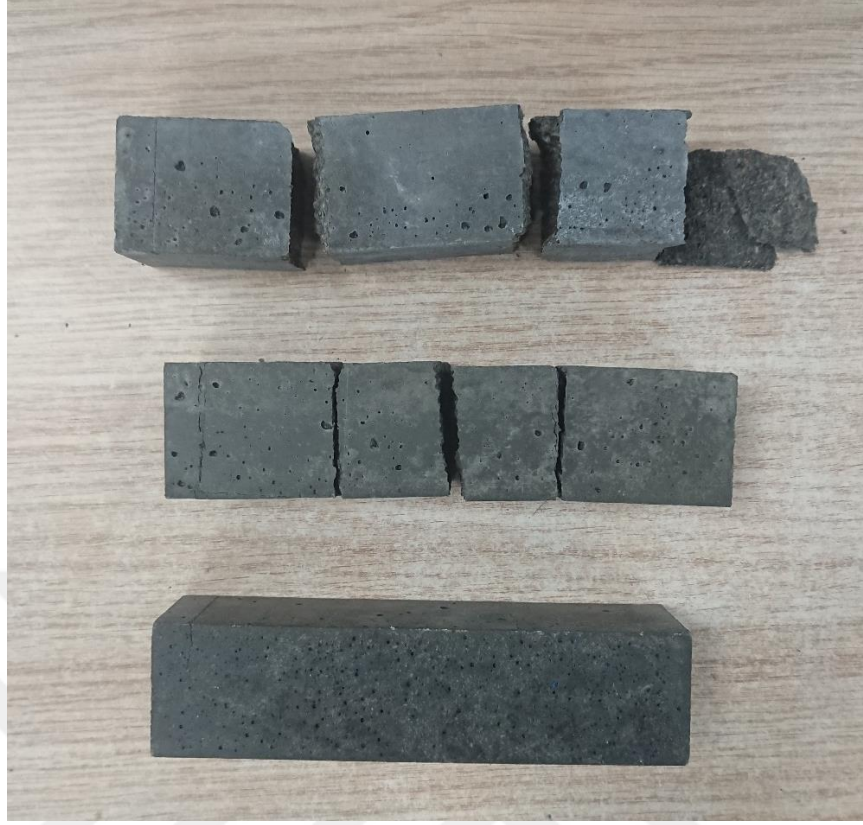
Şekil 3.12 Basınç Dayanımı ölçülmüş numuneler
