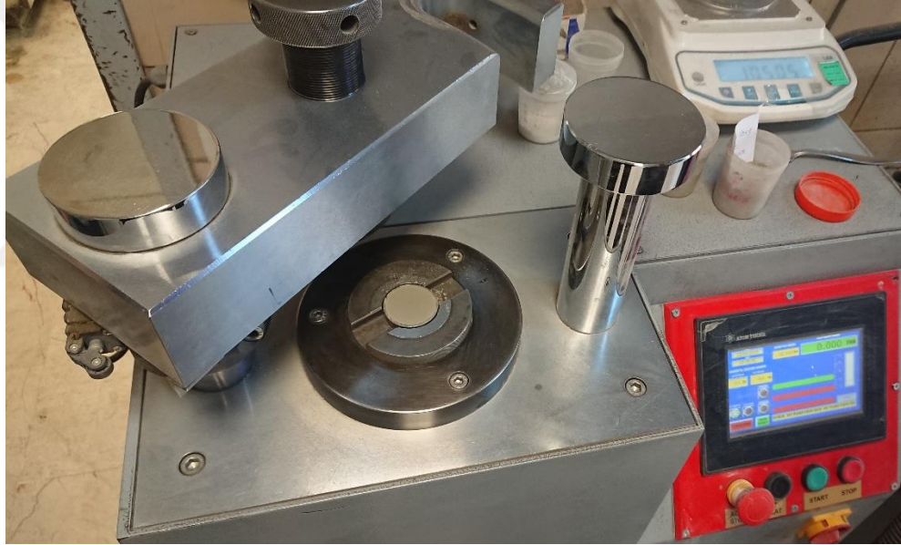
Şekil 3.4 XRF Çimento tableti hazırlanması
