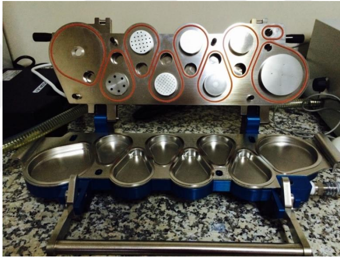
Şekil 13. Yeni nesil impaktör (Next Generation Impactor, Copley) sisteminin bölümlerinin (stage 1-8) açık görüntüsü.
