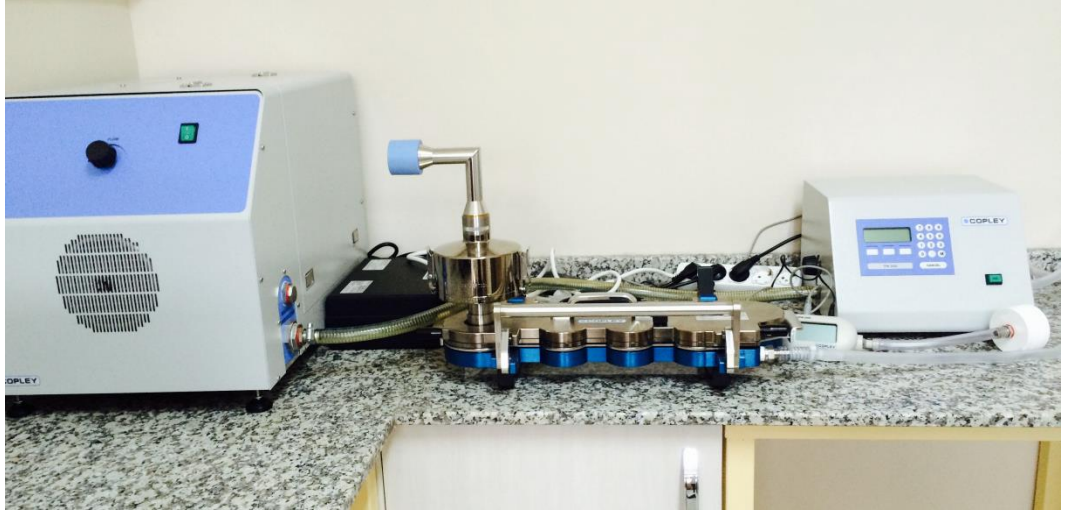
Şekil 12. Yeni nesil impaktör (Next Generation Impactor, Copley) sistemi.
