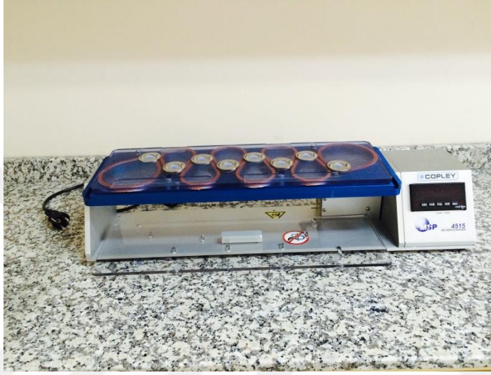
Şekil 15. Yatay çalkalayıcı (Gentle Rocker, Copley).
