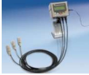
Şekil 2.30 Boşluk suyu basıncı ölçer
