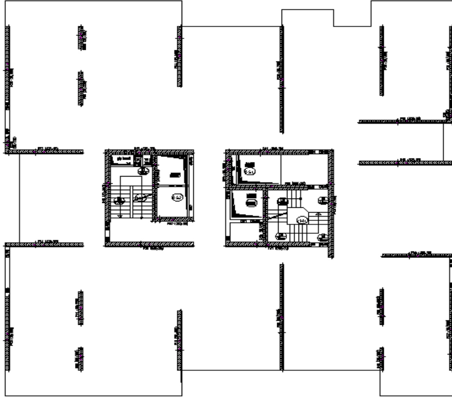
Şekil 3.27: 09 Nolu Binaya Ait Kalıp Planı
