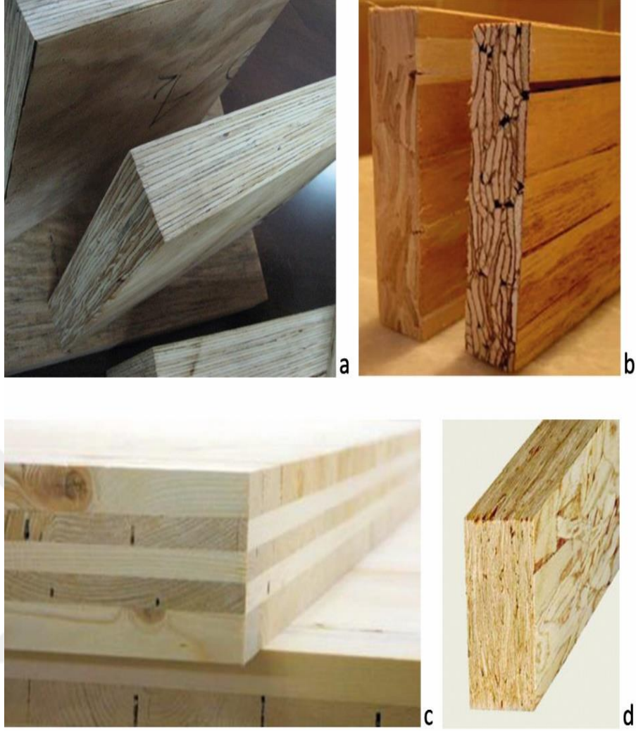
Şekil 1.9. Tutkallı tabakalı ahşap yapı elemanlarındaki son gelişmeler: LVL- lamine kaplama kereste (Laminated Veneer Lumber) (a) [15]; PSL- paralel şerit kereste (Parallel Strand Lumber) (b) [16]; CLT- çapraz lamine ahşap (Cross Laminated Timber); (c) [17] ve LSL – tabakalı şerit kereste (Laminated Strand Lumber) (d) [18]
