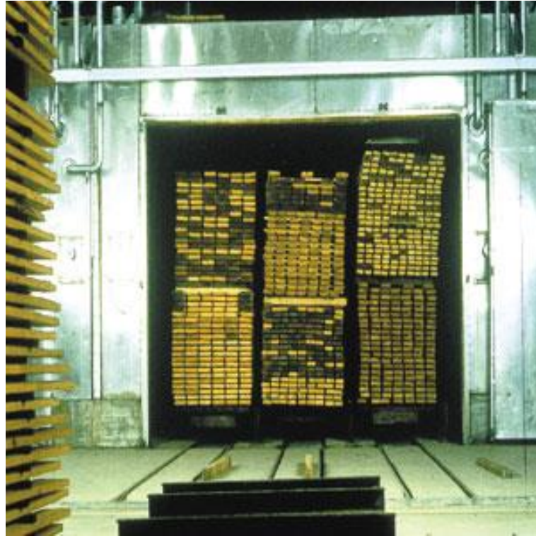
Şekil 1.18.Tabakaların fırınlanması suni kurutma [28]
