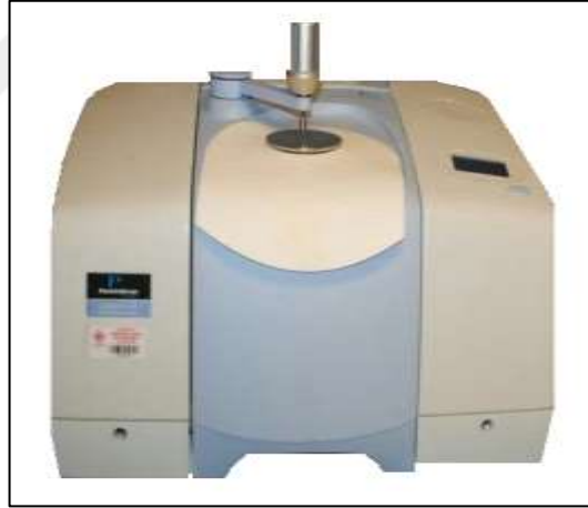
Şekil 2.11. Tez kapsamında kullanılan FTIR (PerkinElmer Spectrum 100)
