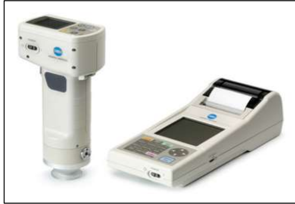
Şekil 2.6. Tez kapsamında kullanılan Konica Minolta CR-400 renk ölçer
