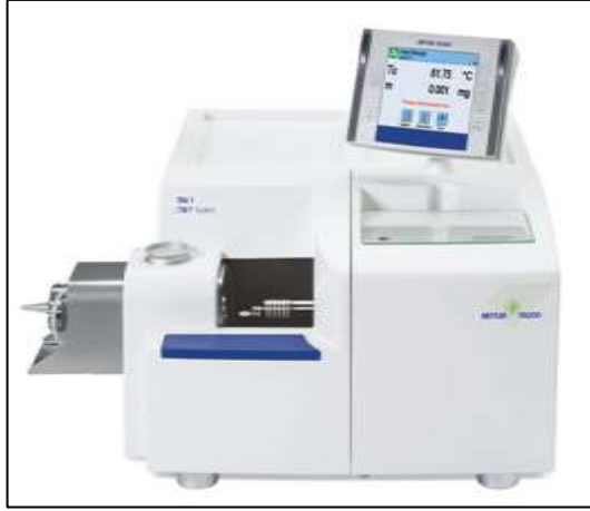
Şekil 2.18. Tez kapsamında kullanılan Mettler Toledo TGA1 model analiz cihazı
