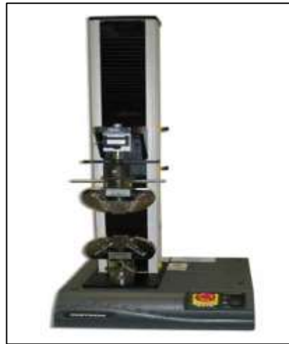
Şekil 2.14. Tez kapsamında kullanılan Instron (Model 3345) mekanik test cihazı
