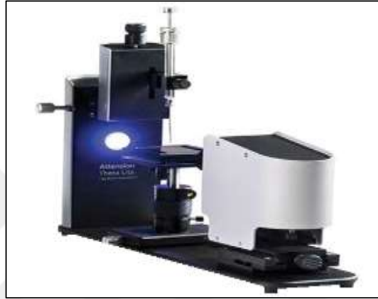
Şekil 2.17. Tez kapsamında kullanılan Attension Theta Lite model temas açısı cihazı
