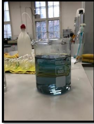
Şekil 4.27 Yıkama işlemi sonrası M1 lifinin absorbladığı boyayı desorplaması sonucu beherdeki deterjanlı yıkama çözeltisinde meydana gelen renk değişimi (yıkama öncesi çözelti rengi şeffaftır)
