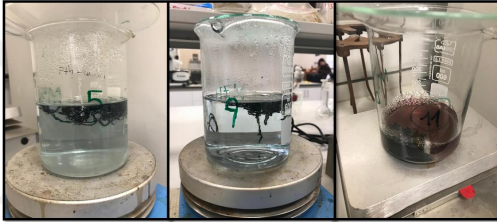
Şekil 4.25 Deterjan ile yıkama işlemi esnasında deterjanlı suda yıkanan liflerin fotoğrafları (soldan sağa sırasıyla M5, M9, M11)
