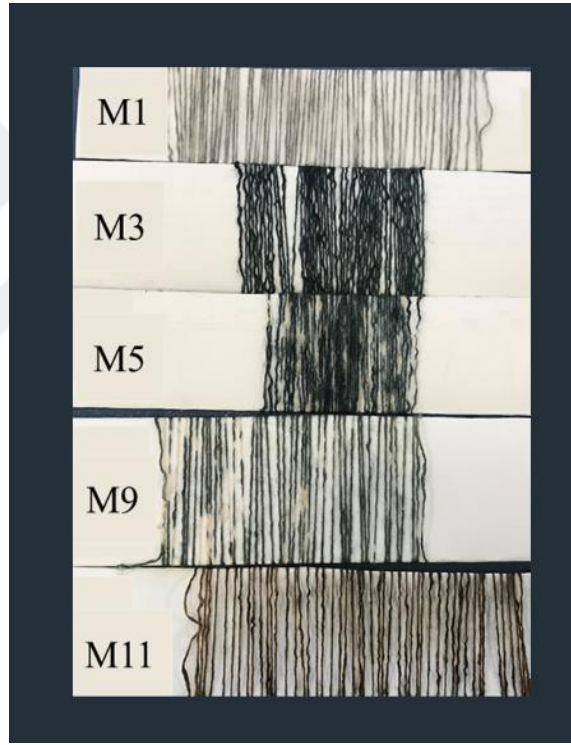
Şekil 4.24 Farklı pH'lara sahip çözeltilerde boyanmış ve laboratuvar ortamında deterjan ile yıkama sonrası analize gönderilmek üzere hazırlanan %80-90 oranlarında HEMA içeren PAN-g-PHEMA lif örneklerinin fotoğrafları (Yıkama Süresi: 30 dakika)
