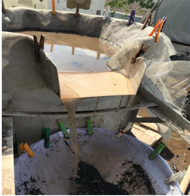
Şekil 3.7 Yüzdürme tankına sinek telinin mandallarla tutturulması ve oluktan karbonlaşmış materyallerin akışı
