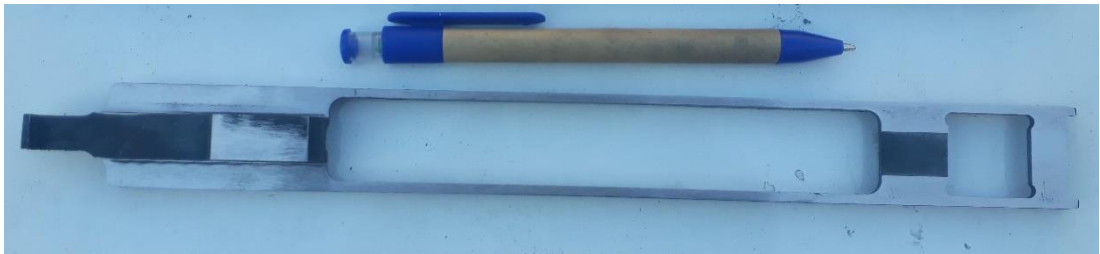
Şekil 3.1. Sürgü kolu parçasının talaşlı imalat yöntemiyle üretilmiş hali
