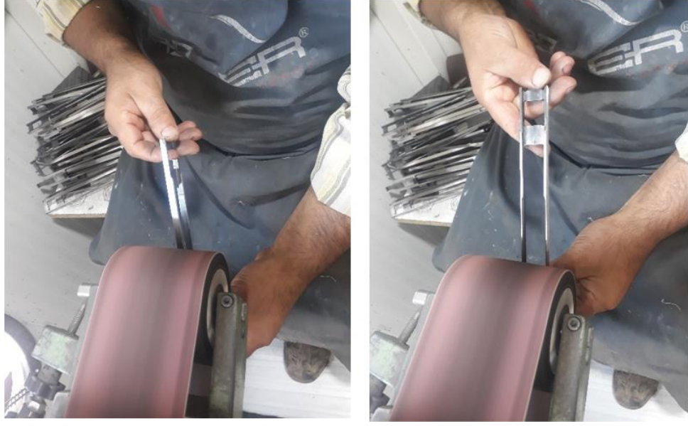
Şekil 3.13. Sürgü kolu parçasının düzeltilmesi
