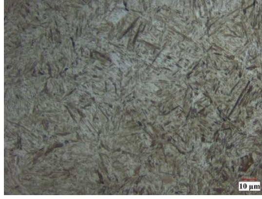
Şekil 4.3. Su verilmiş ama meneviş işlemi uygulanmamış malzemenin iç yapısı
