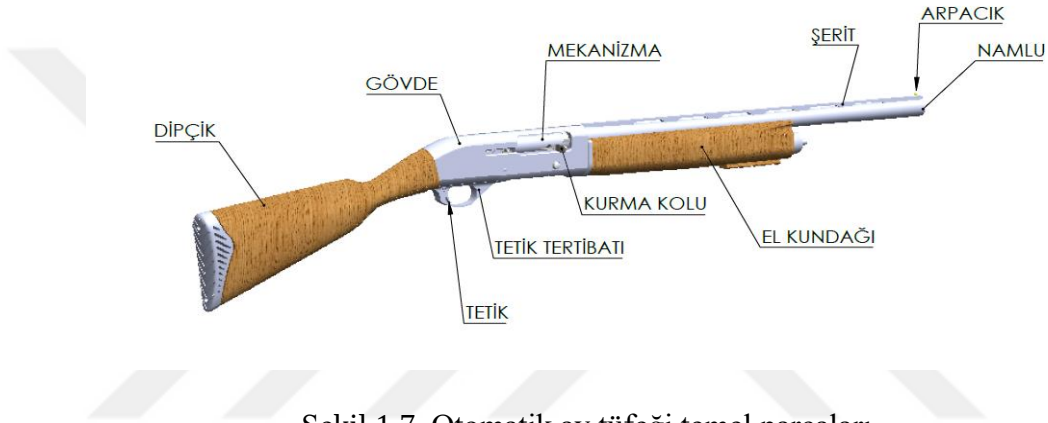
Şekil 1.7. Otomatik av tüfeği temel parçaları
