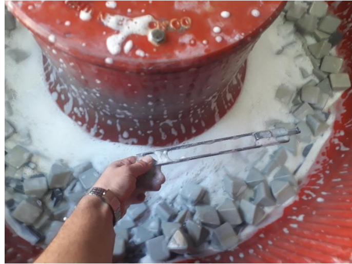
Şekil 3.14. Sürgü kolu parçalarının çapak alma işleminin uygulanması
