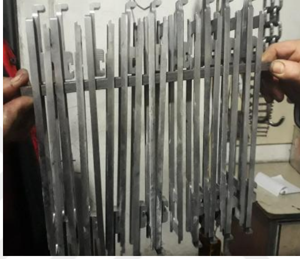
Şekil 3.3. Sürgü kolunun aparata dizilmesi
