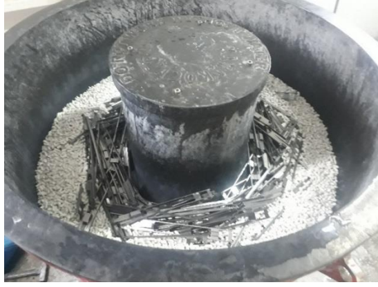
Şekil 3.15. Sürgü kolu parçalarına parlatma işleminin uygulanması
