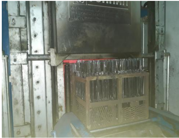
řekil 3.6. Malzemelerin fırının cehennemlik kısmına alınması-I
