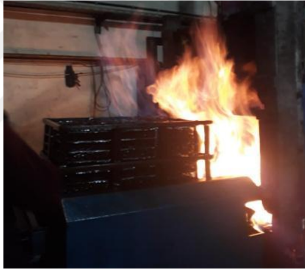
Şekil 3.9. Malzemelerin yağdan çıkarılması
