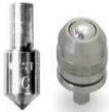
Şekil 1.23. Konik ve bilye batıcı uç (Callister vd., 2013)
