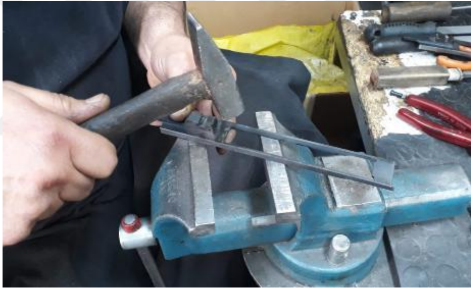
Şekil 3.12. Sürgü kolunun çekiçleme ile düzeltilmesi
