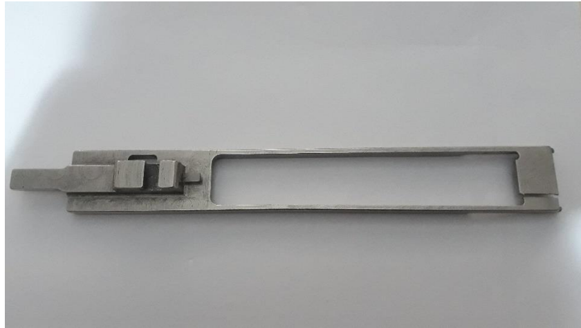
Şekil 5.1. Sadece su verme işlemi uygulanan sürgü kolunun hasara uğraması
