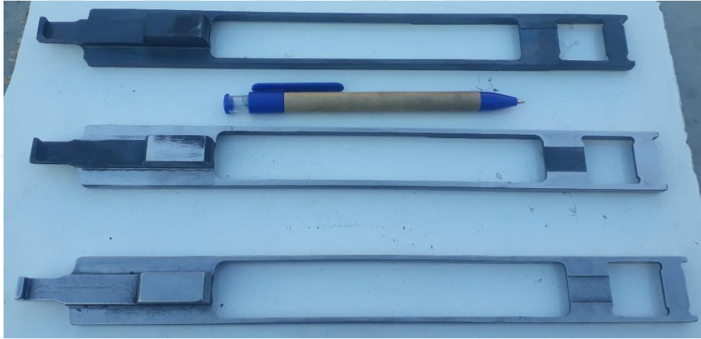
Şekil 3.16. Çekiçleme, tesviye ve vibrasyon işlemi uygulanan sürgü kolları
