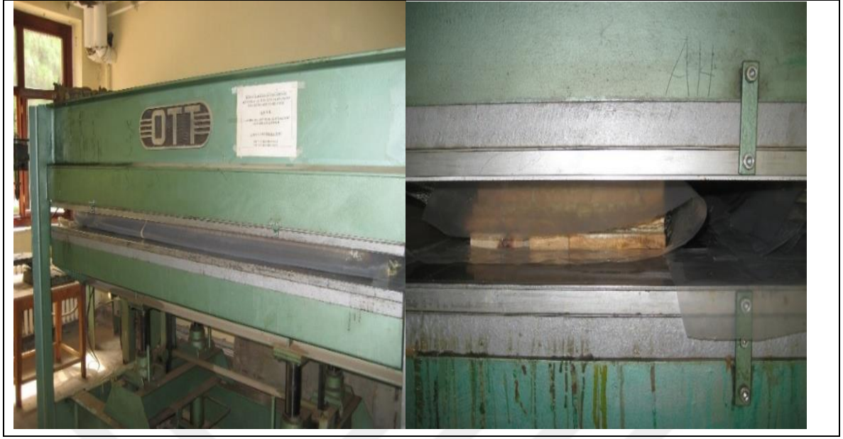
Şekil 3.5. Lamine ahşap yapı elemanlarının preslenmesi
