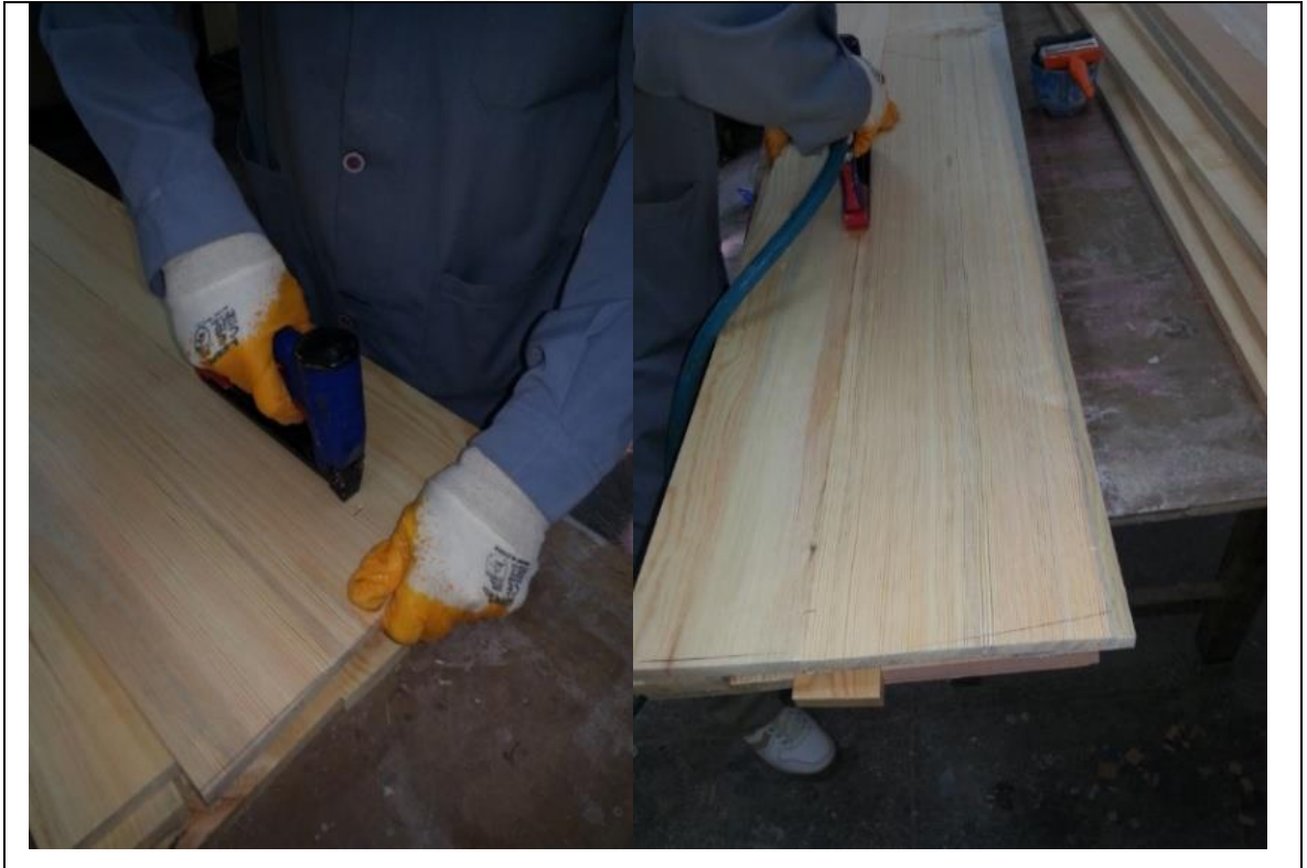
Şekil 3.4. Lamellerin düz en birleştirme yapılan bölgelerine U çivi çakılması
