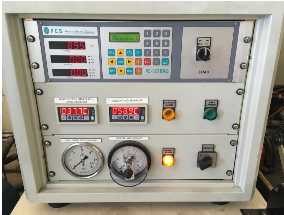
Şekil 3.2. Motor dinamometresi kontrol panosu
