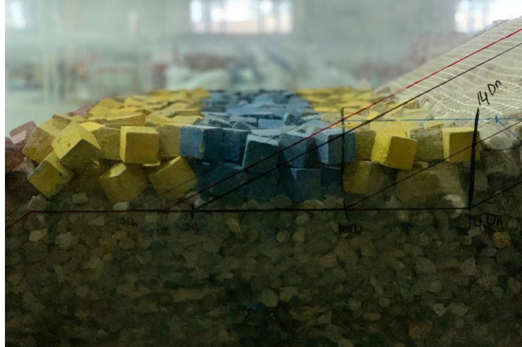
Şekil 3.11 Dalgakıran modelinin basamak detayına ait görünüm
