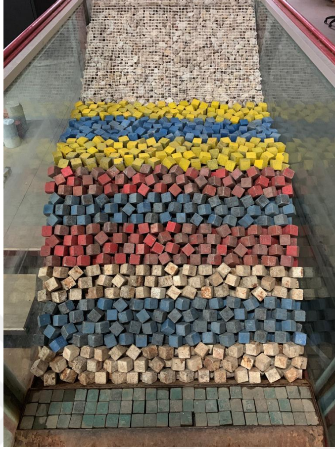
Şekil 3.12 Dalgakıran modelinin önden görünümü
