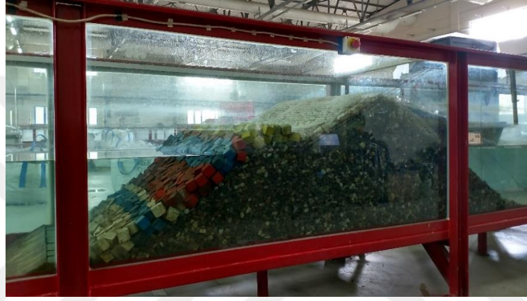
Şekil 3.10 Dalgakıran modellerinden bazılarına ait kesit görünümleri
