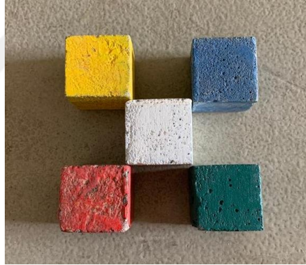
Şekil 3.17 Küp beton eleman
