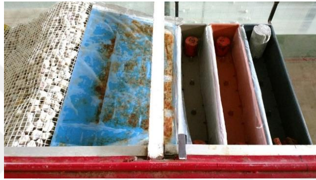
Şekil 3.25 Aşma debisi ölçüm tankları
