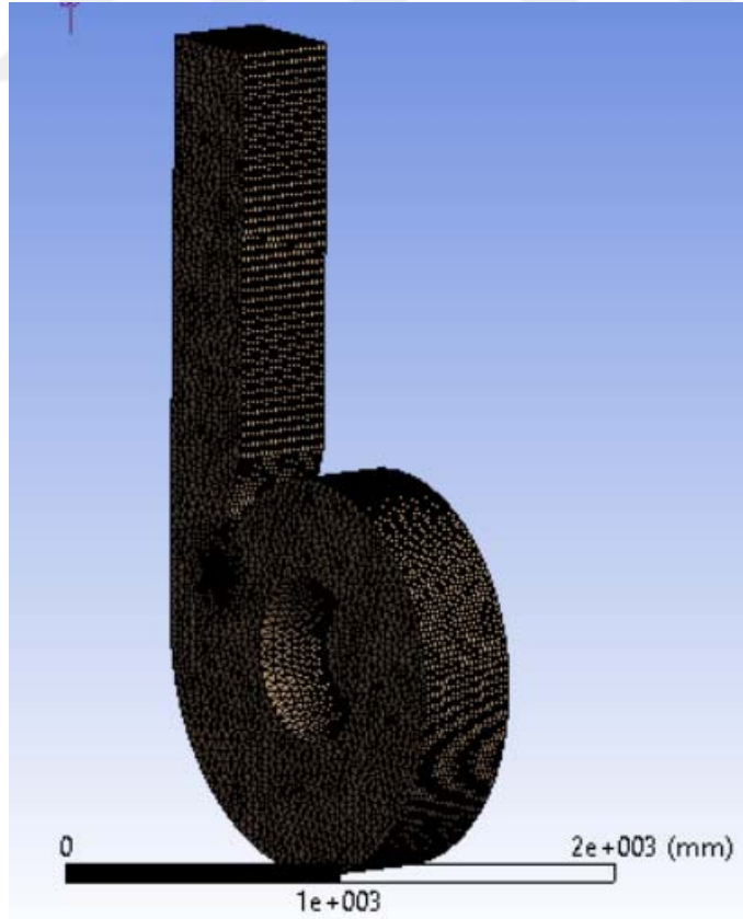
Şekil 6.8. Test edilmiş fanın (CBC fanı) çark ağ yapısı
