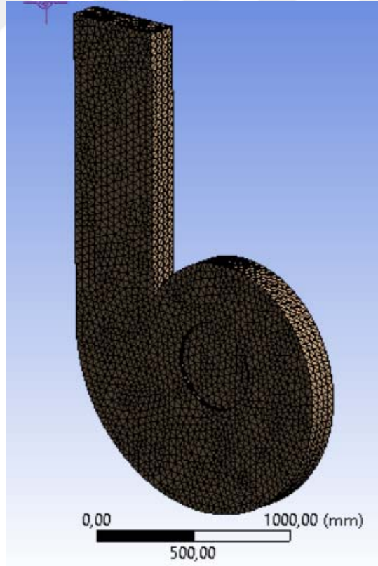
Şekil 6.19. Tasarlanan fanın (Church fanı) çark ağ yapısı
