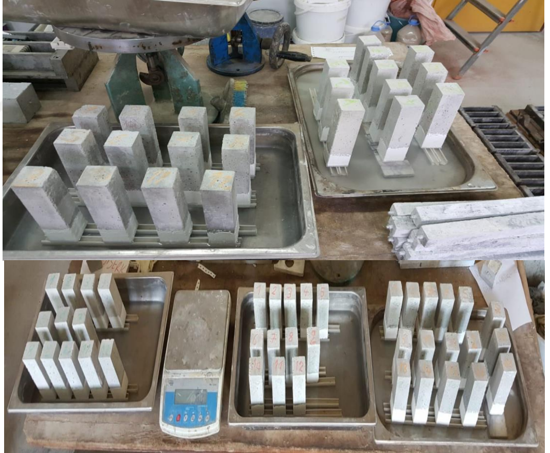
Şekil 3.3. Kılcal su emme deneyi uygulanan numuneler
