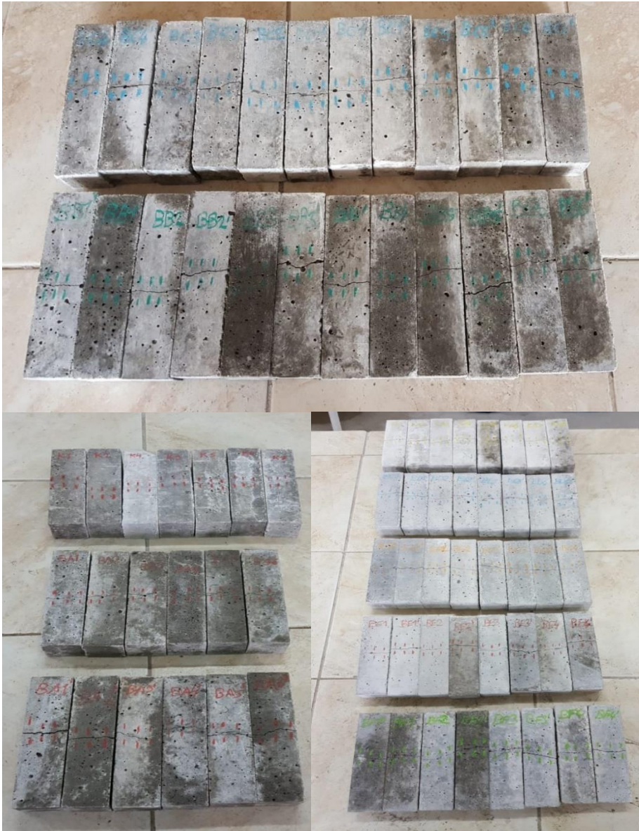
Şekil 3.4. Çatlak oluşturulmuş numuneler
