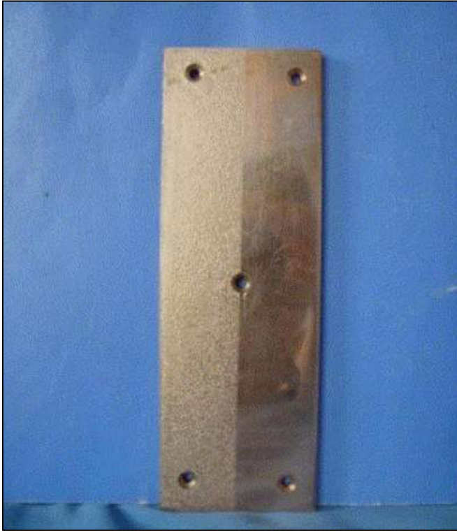
Şekil 4.4. Bir yarı anti-buz kaplaması yapılan metal plaka [38]
