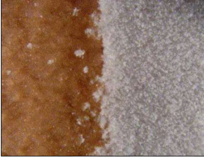
Şekil 4.5. Kaplama yapılan ve yapılmayan yüzeylerin 120 dakika sonundaki durumlarının karşılaştırılması [38]
