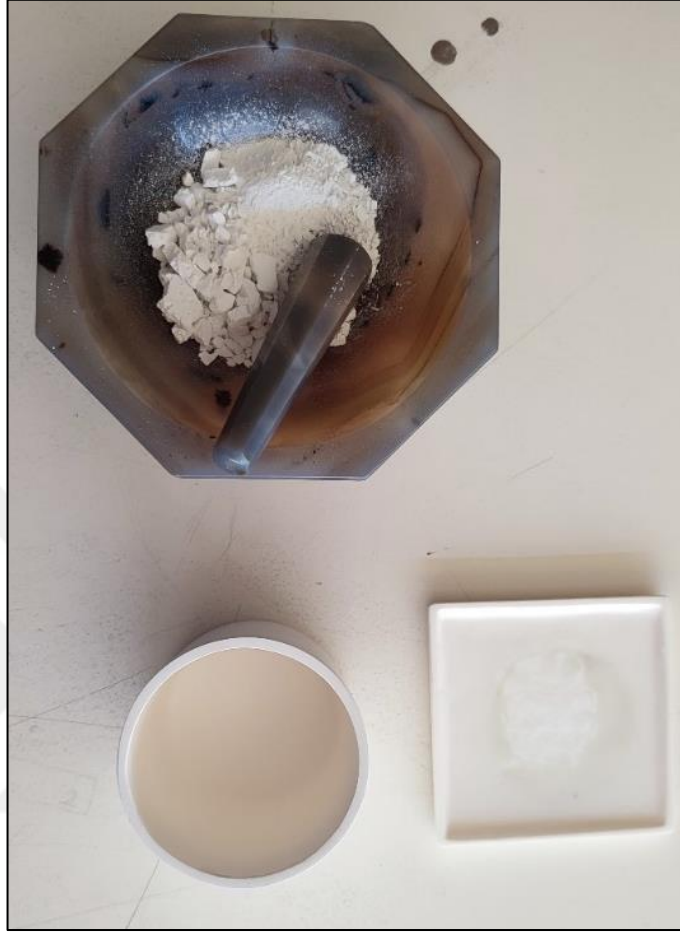
Şekil 3.2: Üretilen BCZT tozu ile dövülme işlemi için kullanılan seramik havan ve kalsinasyon prosesi için kullanılan seramik kap.
