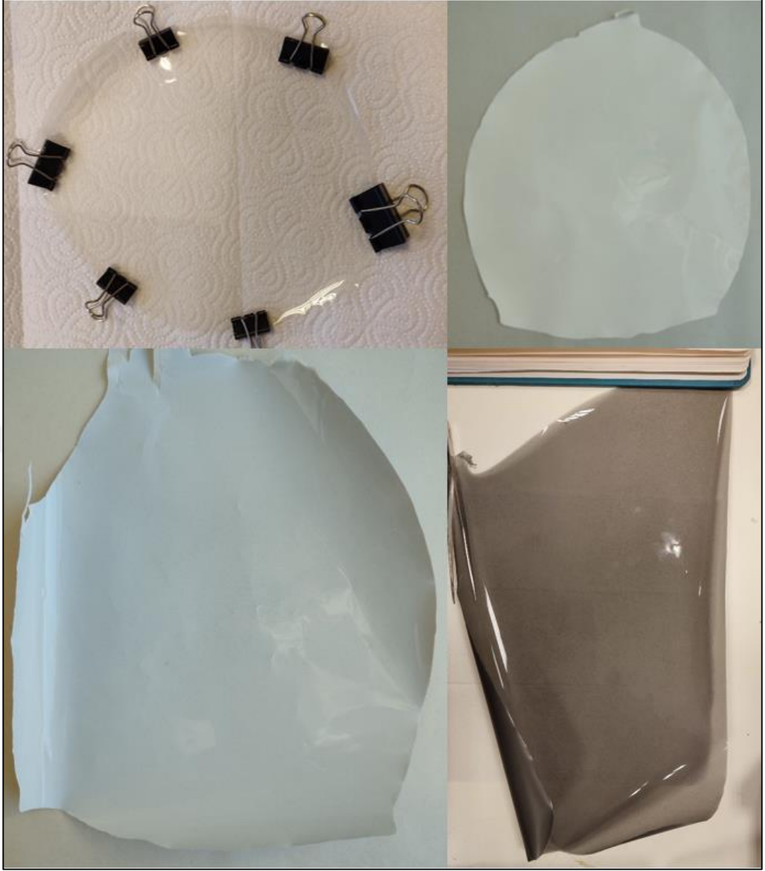
Şekil 3.4: Üretilen piezokompozit filmlerin görselleri a) PVDF, b) %37,5 BCZT+PVDF, c) PVDF+%37,5 BCZT+ 0,5 Grafen, d) PVDF+ 0,5 Grafen.
