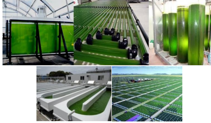
Şekil 2. 17. Kapalı ve açık alg üretim sistemleri (Kükdamar, 2017).
