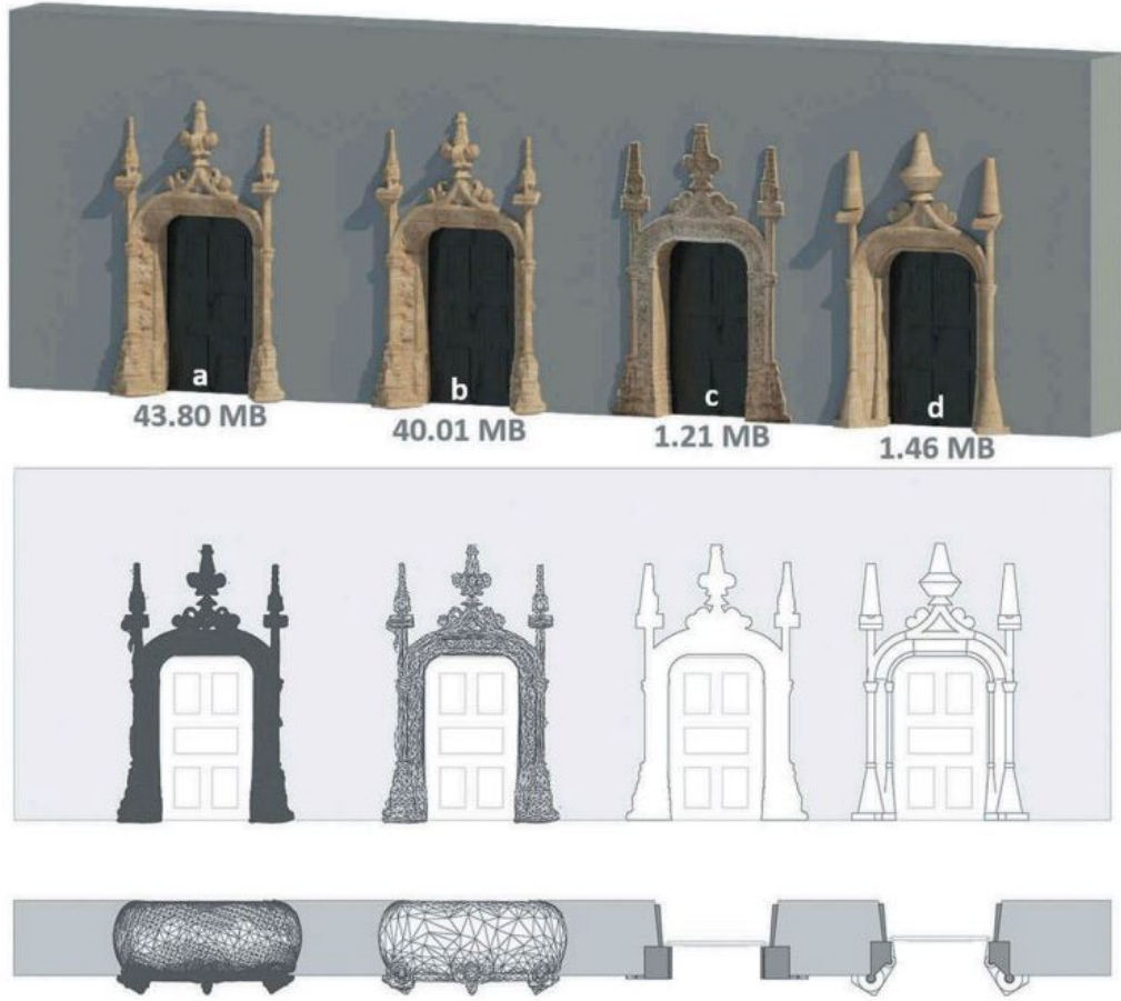
Şekil 4.12. 4 farklı detay seviyesine sahip geometrik şekillerin render ve modelleri
